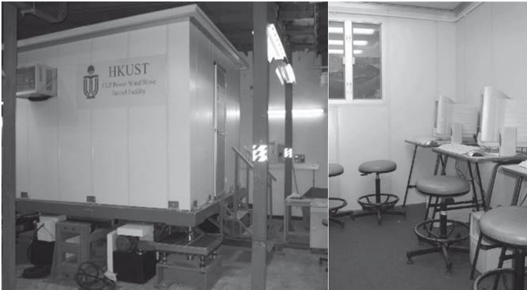
Figura 2.4. Un simulador de movimiento de doble eje, se muestra la sala de pruebas de 3 m por 3 m y el contenido de la sala de pruebas. Esta sala es capaz de simular vibraciones sinusoidales y vibraciones aleatorias de dos grados de libertad en edificios altos con frecuencias dominantes entre 0.1 y 1.2 Hz (adaptadas de C. S. Kwok, Kenny et al (2019). “Wind-Induced Motion of Tall Buildings”).
