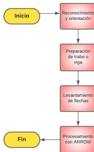
Imagen 22. Diagrama de Flujo para procedimiento de levantamiento de flechas en trabes confinadas
