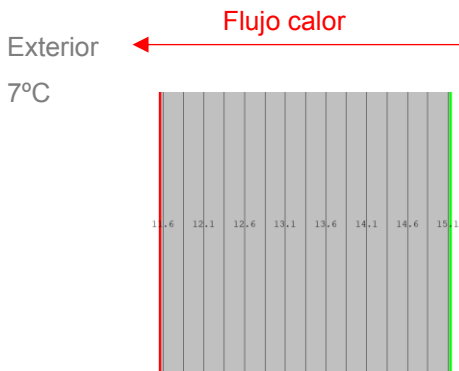
Flujo térmico en envoltente con temperatura exterior a 25°C y 7°C
