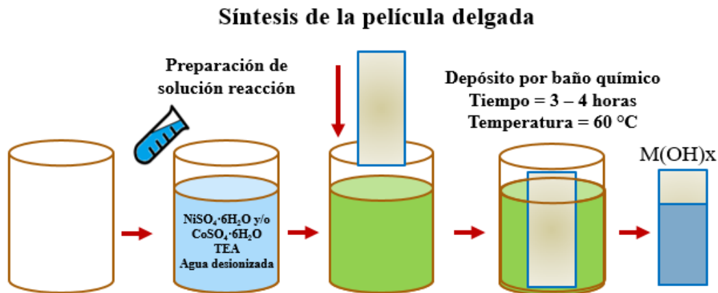
Figura 2.2. Proceso para la síntesis de hidróxidos metálicos a partir de la técnica de baño químico.
