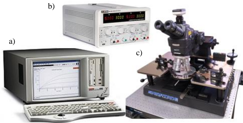
Figura 2.16. Instrumentación empleada para la caracterización del dispositivo. a) Medidor Keithley 4200-SCS, b) fuente de voltaje, c) estación de prueba con microscopio.
