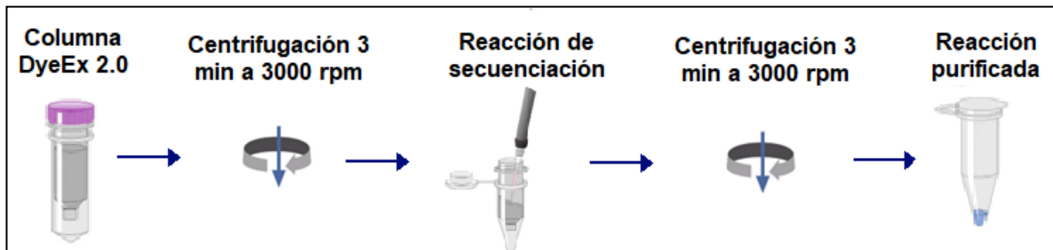
Fig. 8 Protocolo de purificación de reacciones de secuenciación con las columnas DyeEx-Qiagen.
