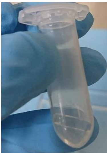
Figura 12. Microtubo con tapa que contiene la parte del plug previamente “recortado” con las medidas requeridas para la restricción enzimática y su posterior corrida electroforética, dicho trozo debe permanecer intacto (sin burbujas, cortes irregulares, y de consistencia firme).
