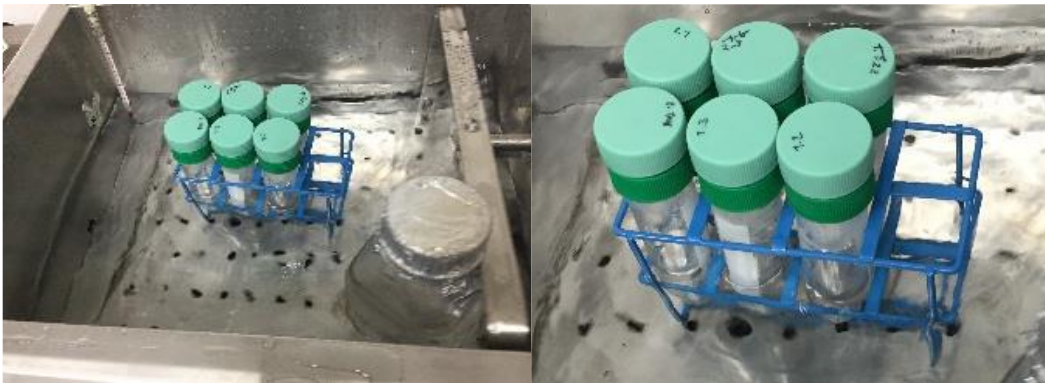
Figura 11. Ejemplo del proceso de lisis celular y posteriormente los lavados, todo se lleva a cabo en tubos cónicos provistos de tapas con cribado (color verde) y tapas comunes (turquesa) respectivamente, estos se incuban en una placa con termo agitación ( 54^{\circ}\text{C} a 175 rpm) y se mantienen estables con ayuda de una gradilla.
