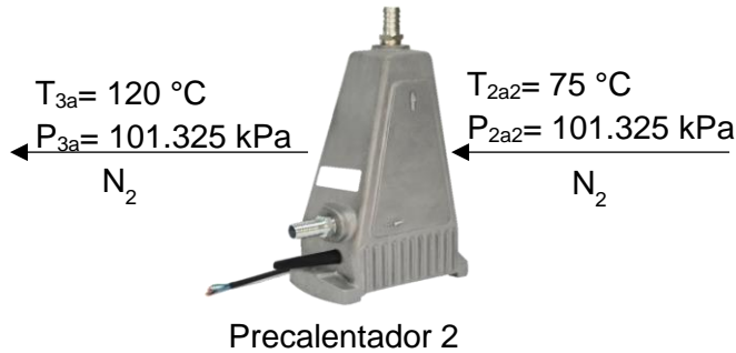
Figura 39. Proceso 2_{a2} - 3_a : Precalentamiento de gas N_2
