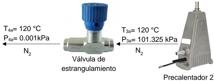
Figura 40. Proceso 3 a -4 a : Reducción de la presión de gas N 2 Nota. Elaboración propia
