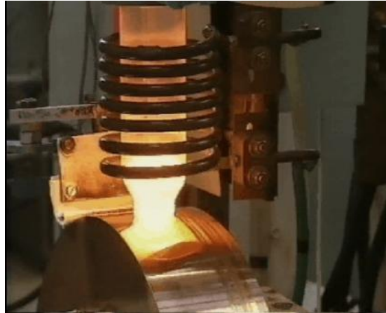
Figura 18. Fotografía del proceso de fabricación por melt spinning.
