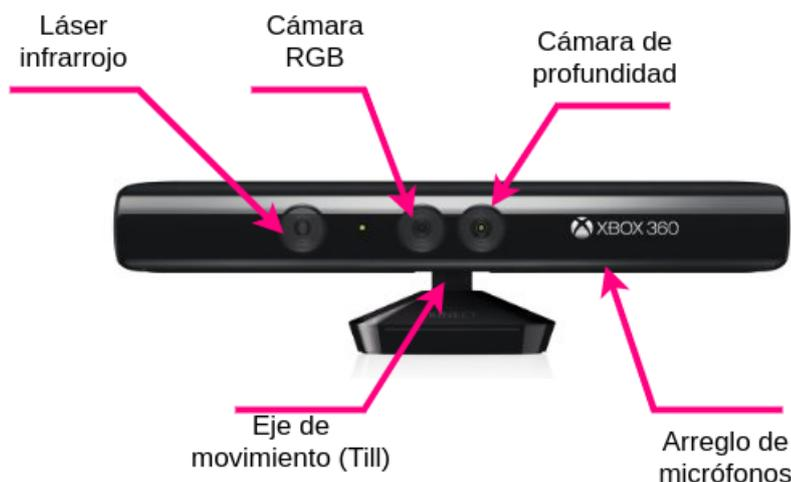
**Figura 2.7:** Foto muestra de Kinect.
