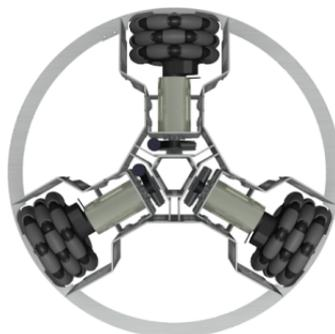
**Figura 5.2:** Estructura de la base omnidireccional del Robotino 3.
