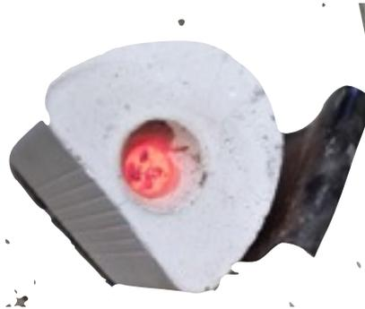
Fig.29 Botón metálico después de la inyección del metal.
