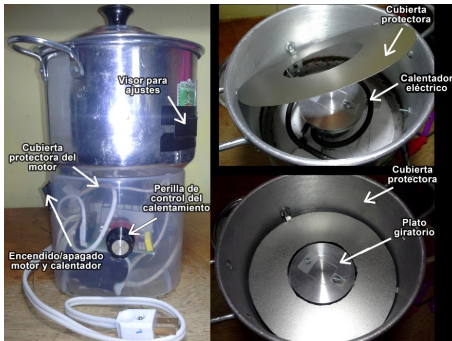
Figura 43. Vista general del dispositivo construido para el proceso spin coating.
