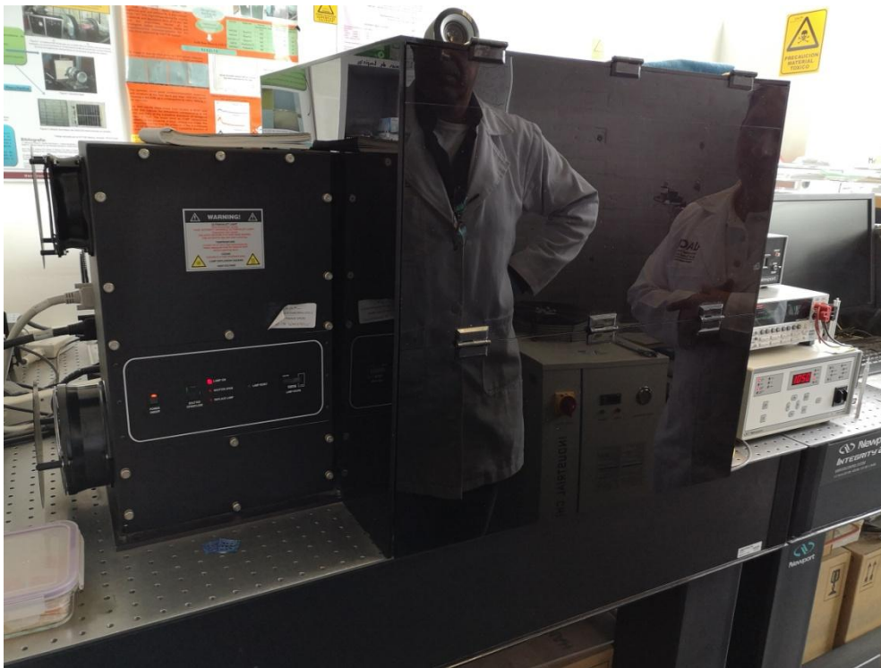
Figura 60. Equipo de simulación solar Oriel I-V test station (Newport).
