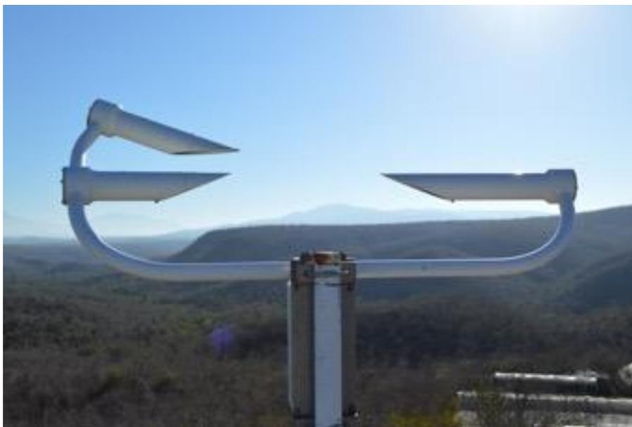
Figura 10. Disdrómetro PWS100, Estación de Biología de Chamela.
