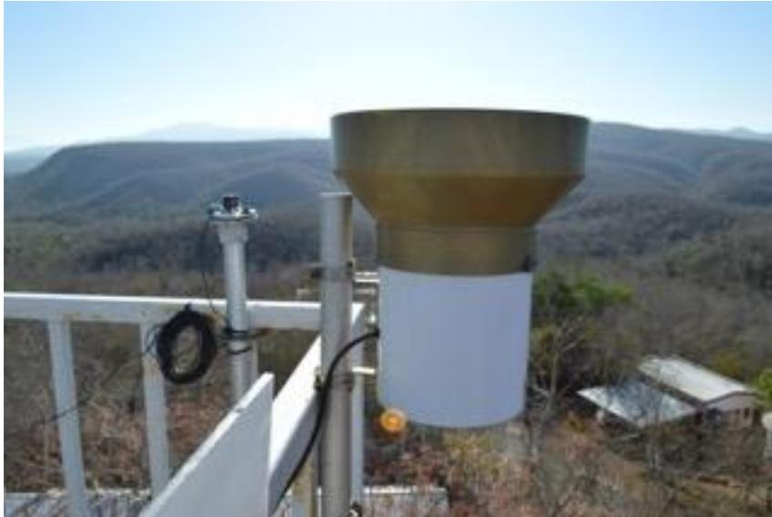
Figura 7. Pluviómetro TR-525M, en la Estación de Biología de Chamela.
