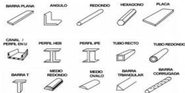
Figura 19 Tipos de Acero estructural (Parra, s.f.)
