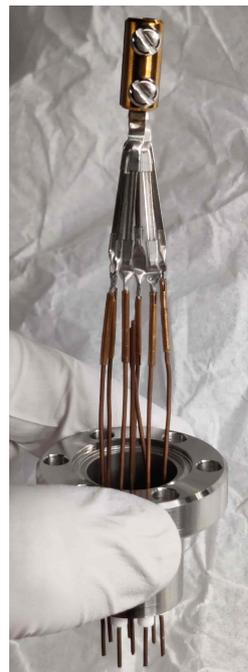
**Figura 3.3.** Foto de los dispensadores que forman parte de la cámara de vacío. Se cambió el anillo de MACOR® por un conector de barril de BeCu.
