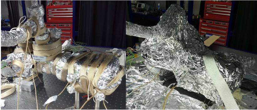
**Figura 3.5.** Fotos del sistema de vacío preparado para el horneado. Las cintas térmicas se colocan encima de la capa de papel aluminio que conduce mejor el calor (izquierda) y luego se cubre todo el sistema con fibra de vidrio y aluminio (derecha) para conservar la temperatura.
