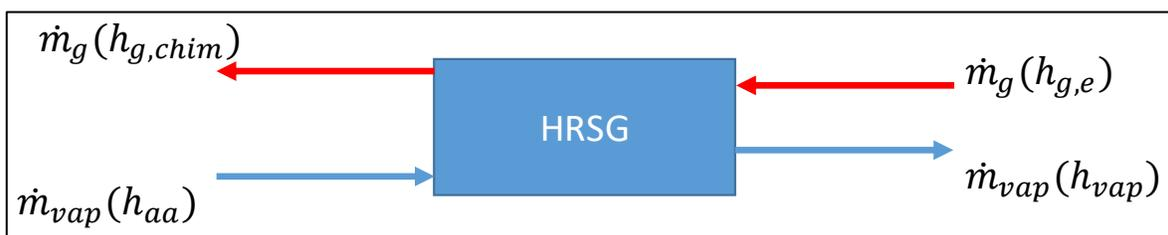
**Figura 3.2.** Diagrama de bloques del balance energético ideal.
