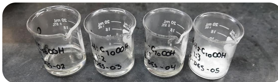
Figura 21. Aspecto físico del NADES C_8OOH:C_{10}OOH en diferentes relaciones molares. De izquierda a derecha relaciones molares 2:1, 1:2, 3:1 y 1:3. Esta fotografía muestra el estado sólido de 1:3. El aspecto físico de la relación 1:1 se muestra en a los experimentos anteriores.
