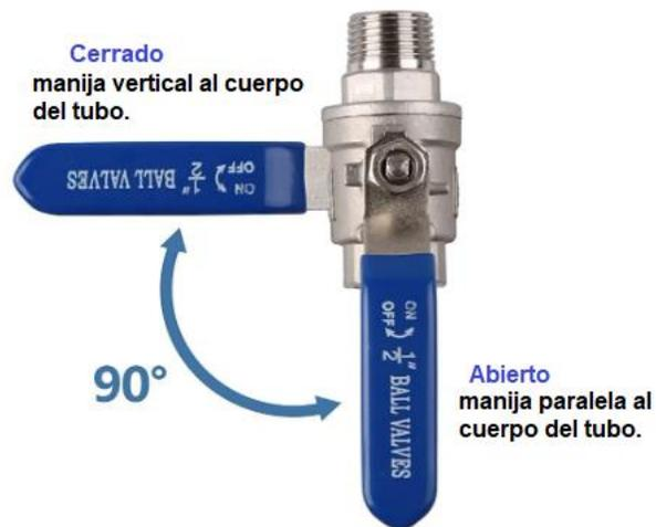
Figura No. 40. Mecanismo de válvula de paso de agua.[36]
