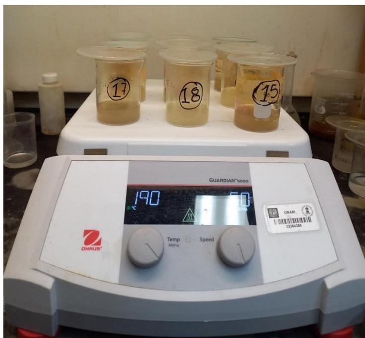
Figura No. 34. Digestión de mineral de Calcopirita y Esfalerita. Medio agua: $\text{HNO}_3$  1:1.
