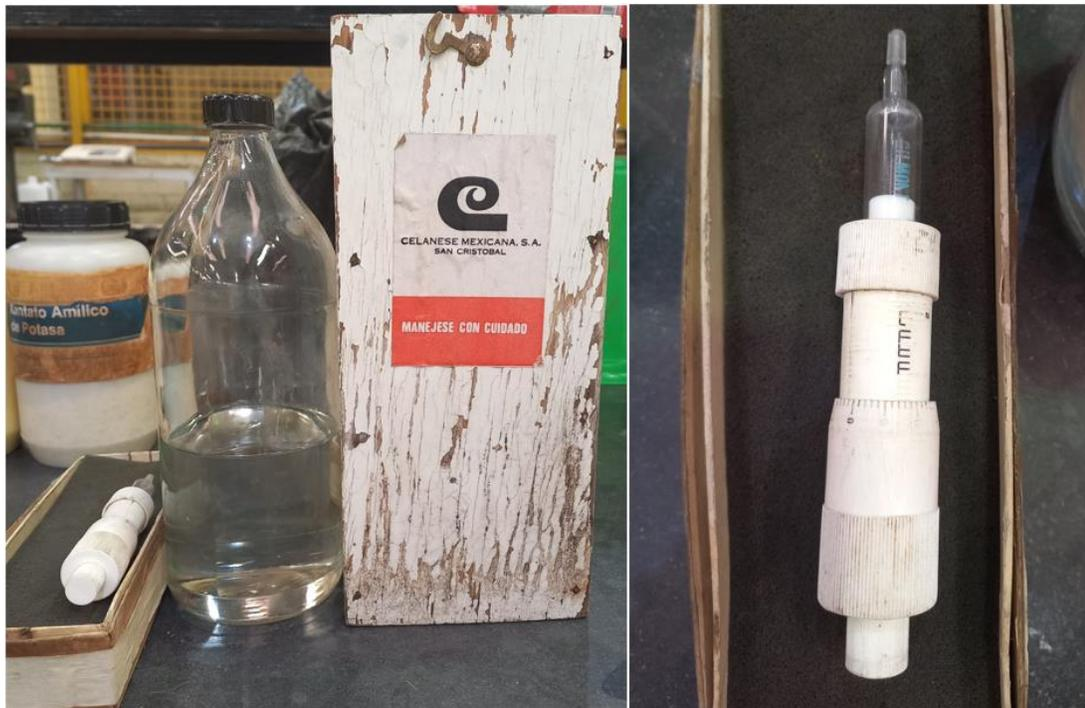
Figura No. 33. Espumante MIBC, con gotero para adición.
