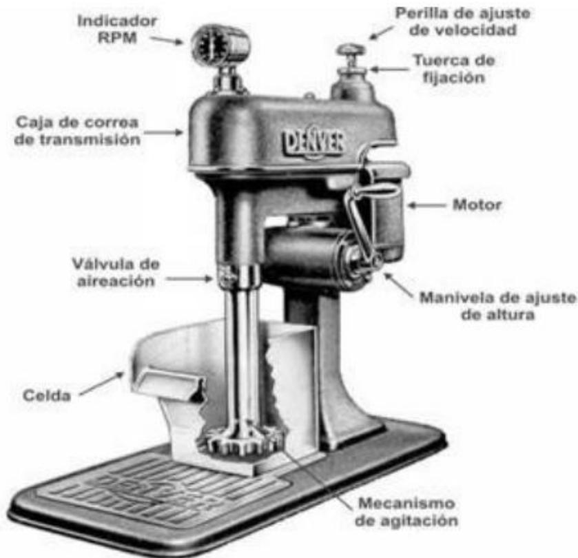
Figura No. 11. Esquema de una máquina de flotación marca Denver para pruebas de laboratorio.[50]
