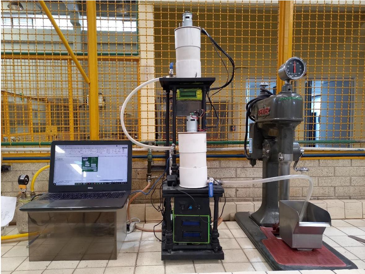
*Figura No. 39. Armado e implementación de sistema determinador de oxígeno disuelto en laboratorio de procesamiento de minerales.*
