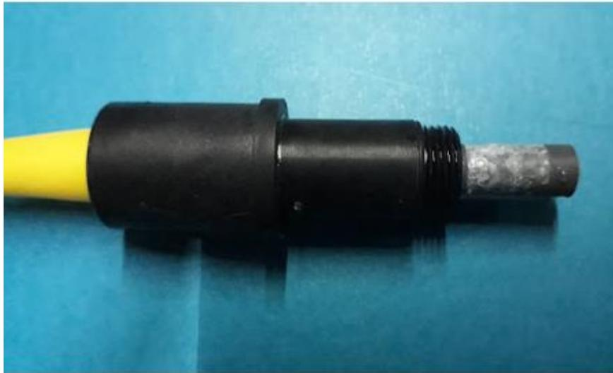
*Figura No. 37. Sonda de oxígeno disuelto posterior al mantenimiento correctivo.*
