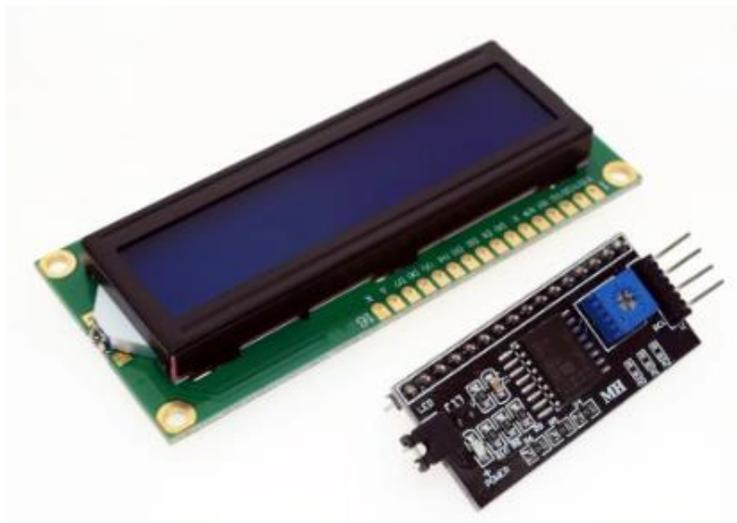
*Figura No. 18. Display LCD 16x2 con microcontrolador I2C [49]*
