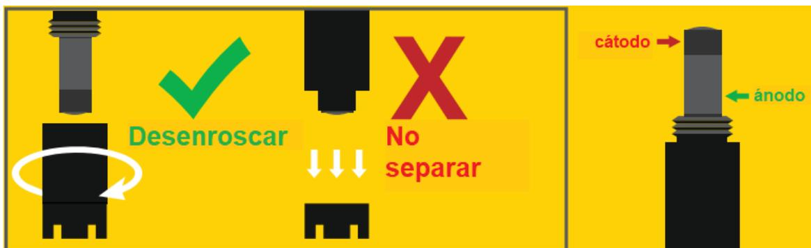
Figura No. 52. Reacondicionamiento de sonda. [31]
