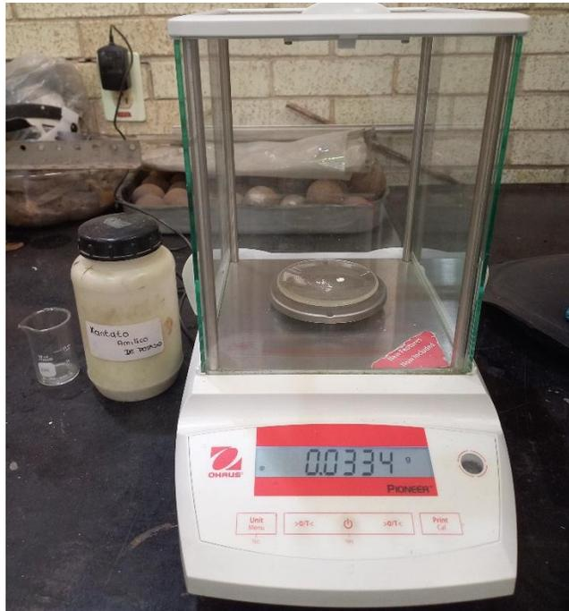
Figura No. 31. Peso de reactivo colector XAK en balanza analítica.
