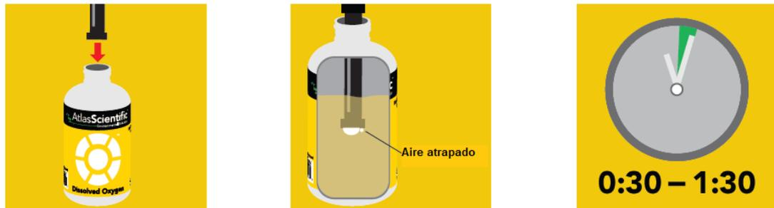
Figura No. 60. Sonda dentro de solución de calibración Zero D.O. [31]
