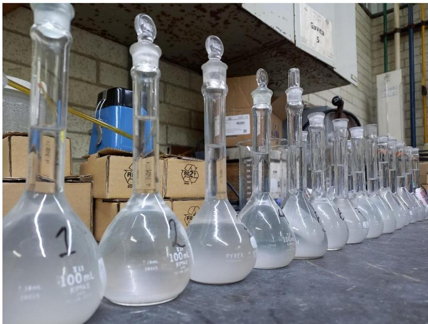
*Figura No. 35. Preparación de dilución de muestras minerales de calcopirita y esfalerita para lectura de absorción atómica.*
