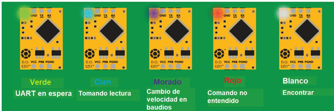
Figura No. 51. Definición de cada color que muestre el LED en sensor EZO al emitir un comando correctamente. [31]
