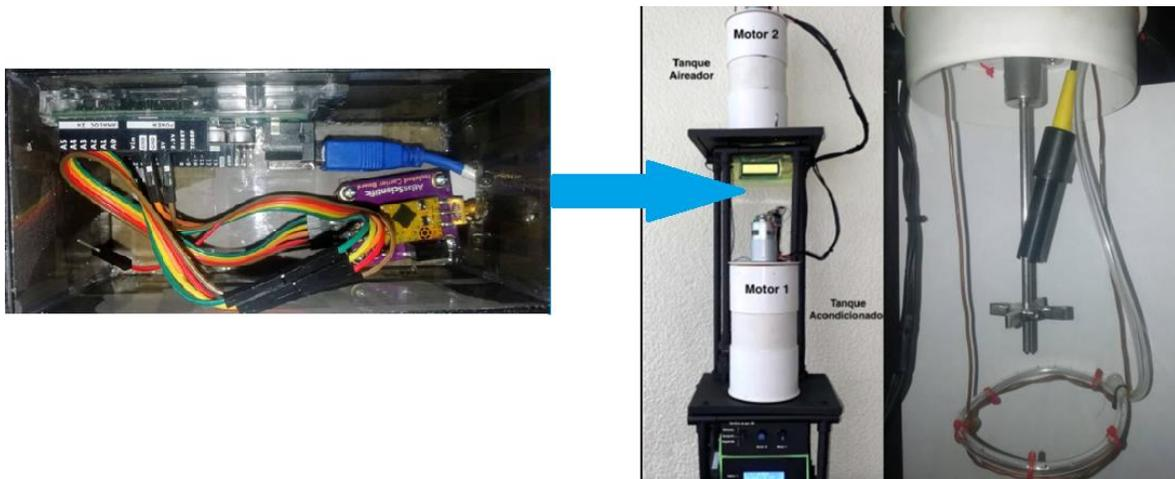
*Figura No. 38. Acoplamiento de sistema determinador de oxígeno disuelto al sistema de aireación y acondicionamiento.*
