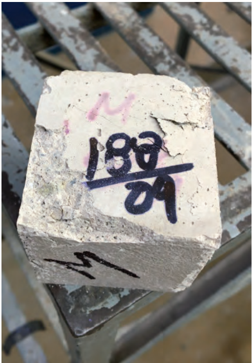
Figura 89. (Daniela Cruz Martínez, 2021) Probeta 188-09 después de ceder ante la falla.
