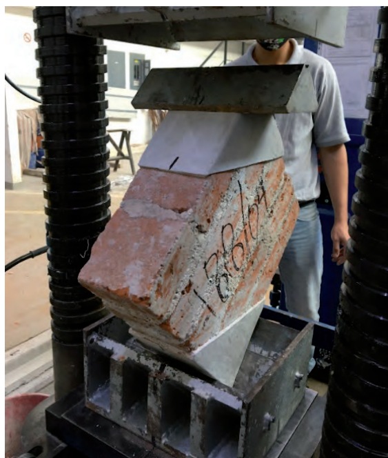
Figura 68. (Daniela Cruz Martínez, 2021) Colocación de cabezales metálicos y alineación con máquina de ensayos universal.
