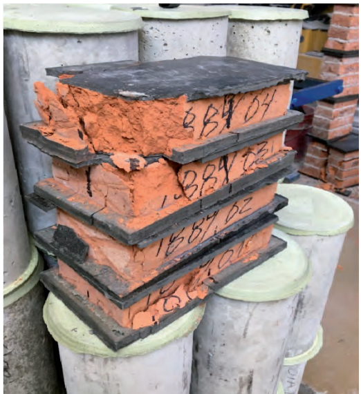
Figura 78. (Daniela Cruz Martínez, 2021) Fractura de las muestras y el mortero de cabeceado.
