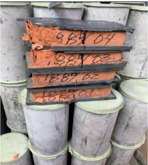
Figura 77. (Daniela Cruz Martínez, 2021) Muestras del material compuesto tras ensayo a compresión.
