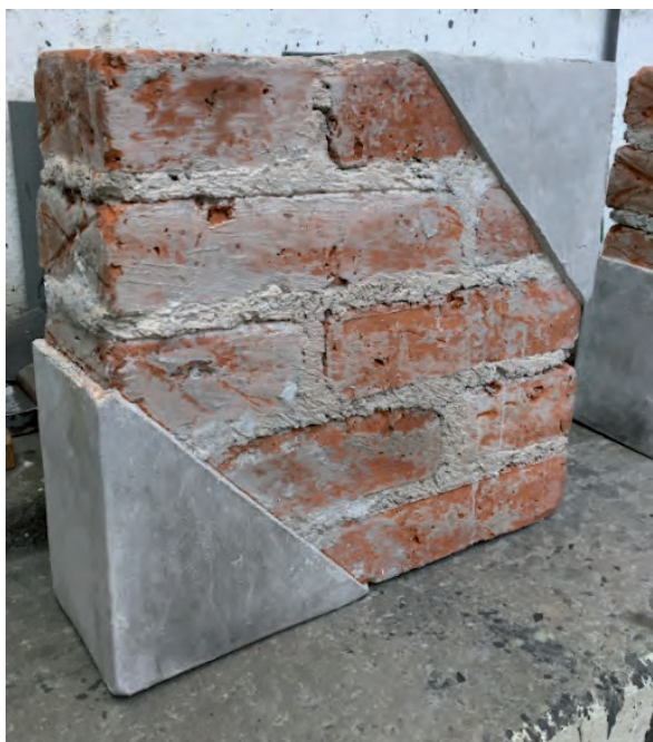
Figura 67. (Daniela Cruz Martínez, 2021) Muretes para ser sometidos al ensayo de resistencia a compresión diagonal.
