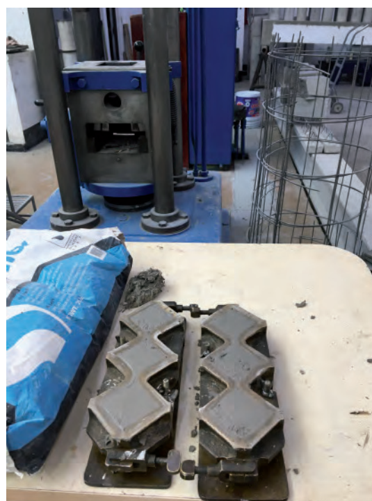
Figura 64. (Daniela Cruz Martínez, 2021) Colocación de pruebas del mortero en moldes metálicos.
