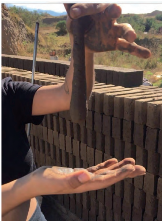
Figura 44. (Daniela Cruz Martínez, 2020) Prueba de límite plástico en muestras con acetato de celulosa.
