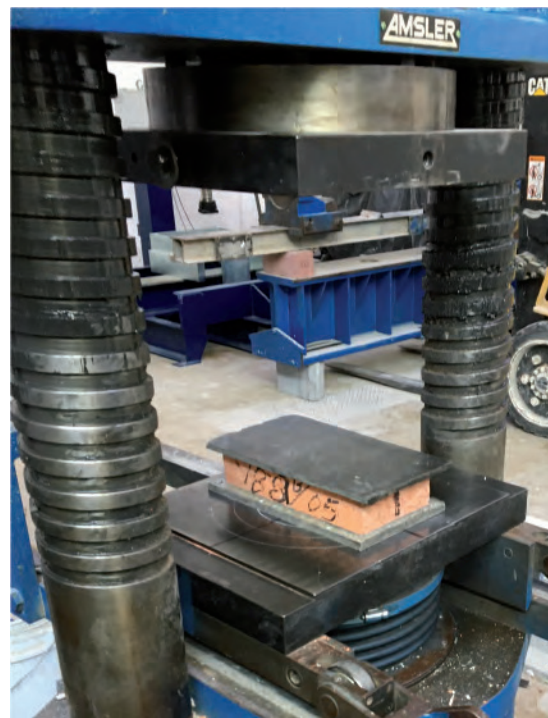
Figura 66. (Daniela Cruz Martínez, 2021) Cabeceo de muestras individuales con mortero de azufre para elaboración de ensayo de resistencia.
