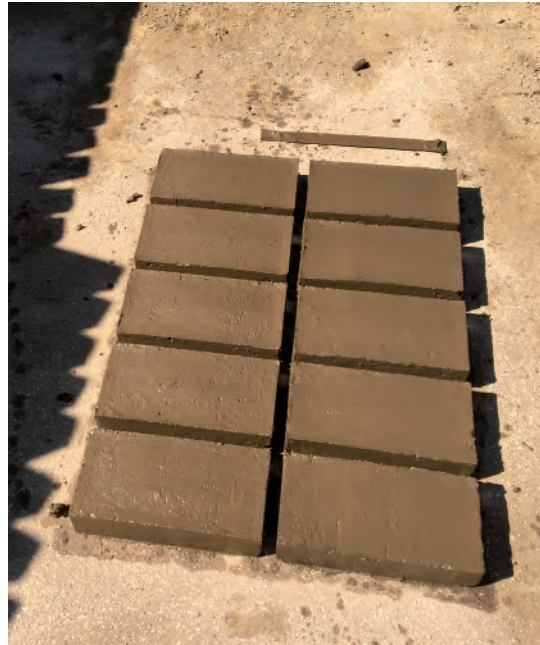
Figura 46 y 47. (Daniela Cruz Martínez, 2020) Mezclas desmoldadas sin desprendimiento del material.
