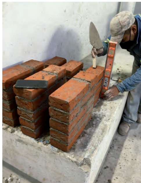
Figura 61. (Daniela Cruz Martínez, 2021) Verificación del junteo de las muestras a plomo con nivel.
