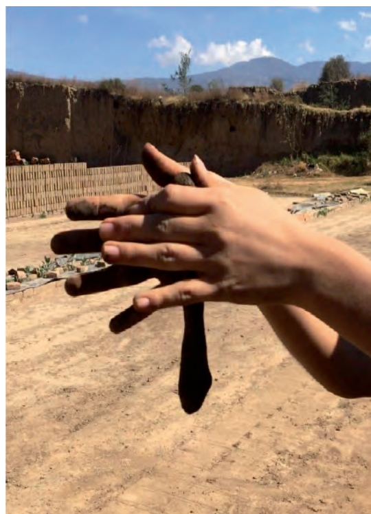
Figura 45. (Daniela Cruz Martínez, 2020) Mezcla lograda de aserrín, arcilla y agua.
