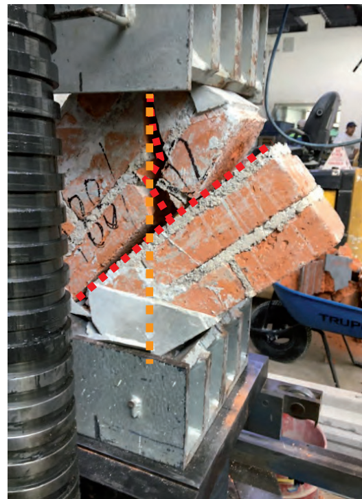
Figura 81. (Daniela Cruz Martínez, 2021) Falla identificada en la probeta por deslizamiento y tensión en diagonal en juntas.
