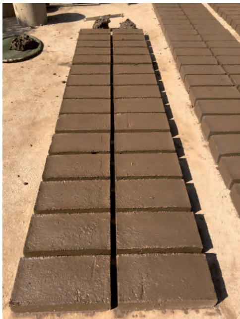
Figura 46 y 47. (Daniela Cruz Martínez, 2020) Mezclas desmoldadas sin desprendimiento del material.
