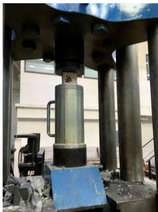
Figura 72. (Daniela Cruz Martínez, 2021) Aplicación de la carga a un espécimen de mortero.
