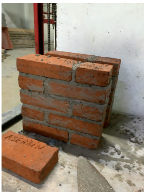
Figura 58. (Daniela Cruz Martínez, 2021) Elaboración de muretes con muestras control.
