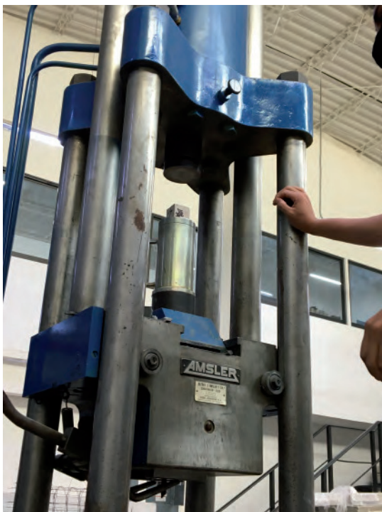
Figura 65. (Daniela Cruz Martínez, 2021) Máquina de ensayos universal AMSLER utilizada para los ensayos.
