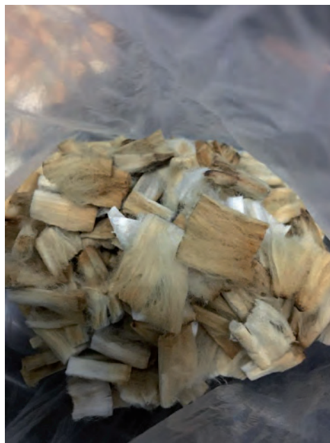
Figura 29 y 30. (Daniela Cruz Martínez, 2020) Desintegración manual de los filtros de acetato de celulosa.
