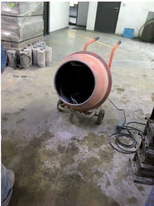
Figura 57. (Daniela Cruz Martínez, 2021) Mezclado del mortero de junteo en revolvedora de concreto.
