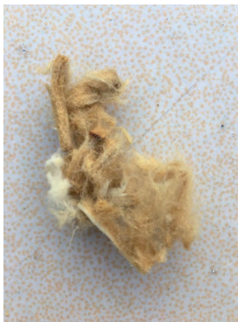
Figura 31 y 32. (Daniela Cruz Martínez, 2020) Acetato de celulosa con apariencia similar a una fibra textil tras triturarse en la licuadora.
