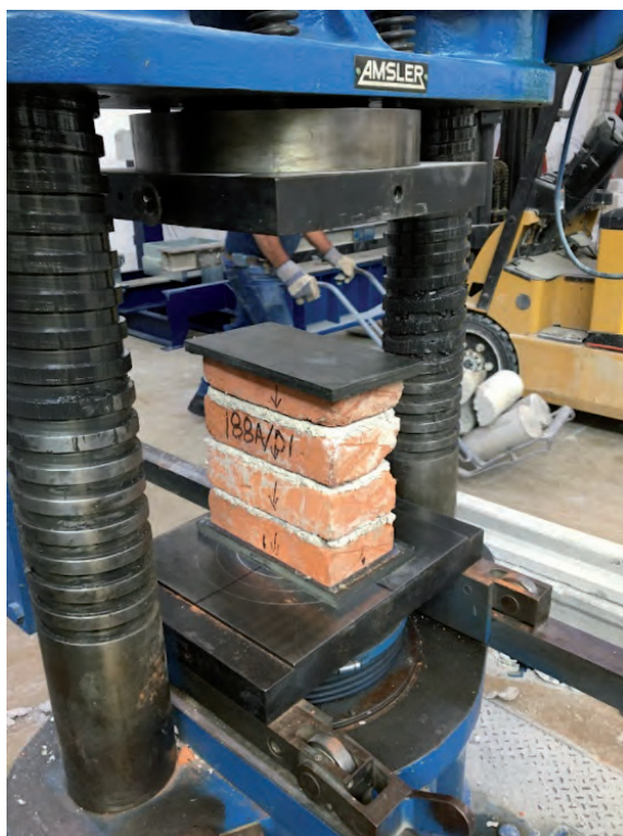
Figura 69. (Daniela Cruz Martínez, 2021) Pilas cabeceadas de mortero de azufre para ensaye.
