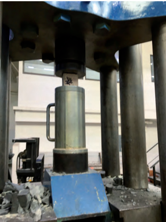
Figura 88. (Daniela Cruz Martínez, 2021) Momento de la falla del mortero de junteo para muretes.
