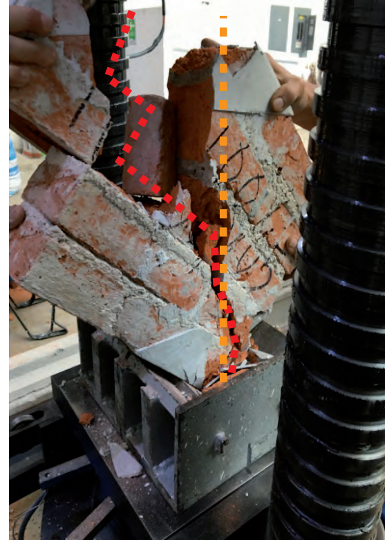
Figura 83. (Daniela Cruz Martínez, 2021) Falla identificada en la probeta por tensión en diagonal en juntas.
