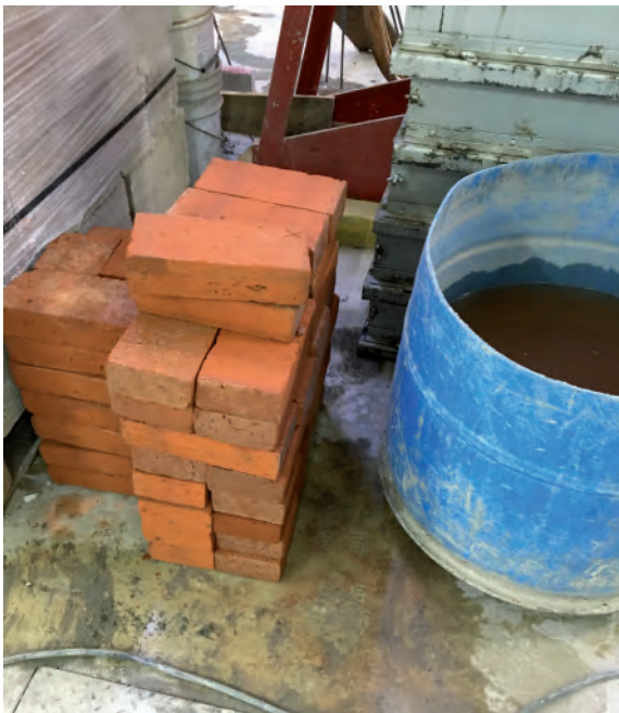
Figura 56. (Daniela Cruz Martínez, 2021) Muestras apiladas tras ser sumergidas en agua.
