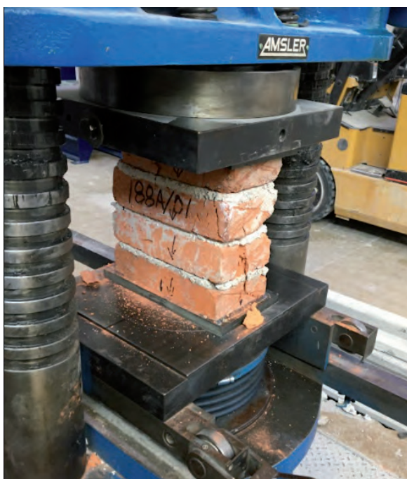
Figura 84. (Daniela Cruz Martínez, 2021) Momento de falla tras aplicación de la carga en probeta 188A-01.
