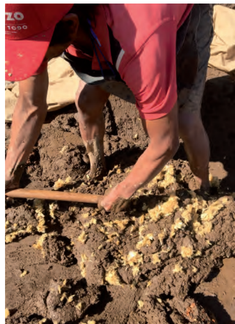
Figura 39. (Daniela Cruz Martínez, 2020) Acetato de celulosa en la mezcla con arcilla y agua.
