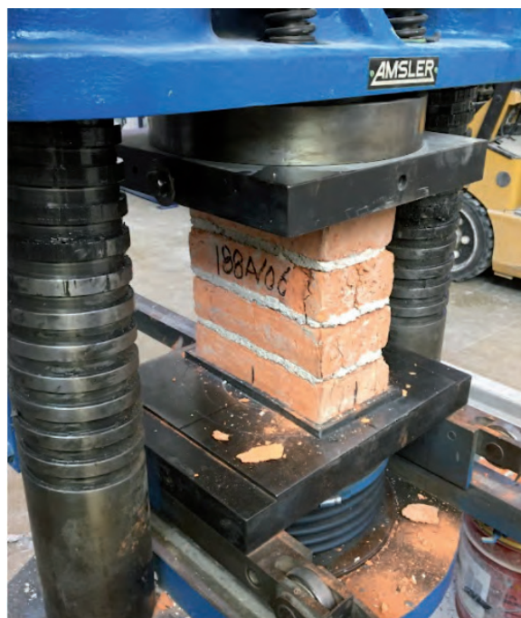
Figura 85. (Daniela Cruz Martínez, 2021) Momento de falla tras aplicación de la carga en probeta 188A-06.
