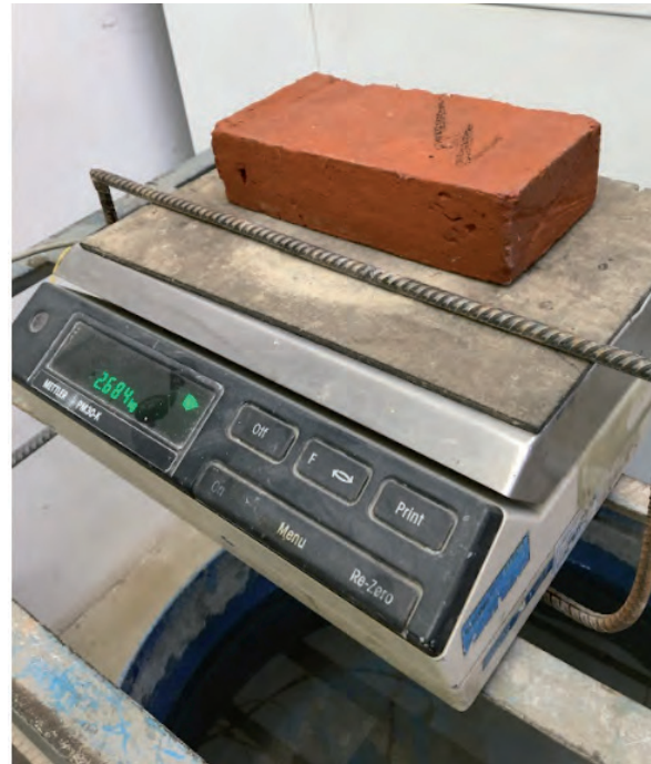
Figura 74. (Daniela Cruz Martínez, 2021) Pesado de la muestra 3 después de ser sumergida.
