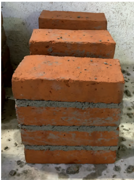
Figura 60. (Daniela Cruz Martínez, 2021) Elaboración de pilas, muestras con 1% de acetato de celulosa.
