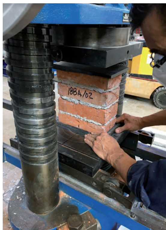
Figura 70. (Daniela Cruz Martínez, 2021) Colocación de la pila al centro del eje de la máquina de ensayos universal.
