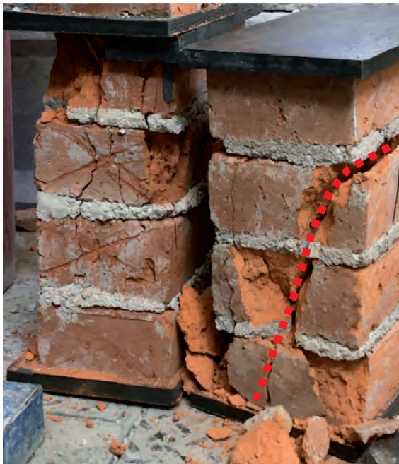
Figura 86. (Daniela Cruz Martínez, 2021) Probeta 188A-03 (material compuesto) tras ceder a la falla.
