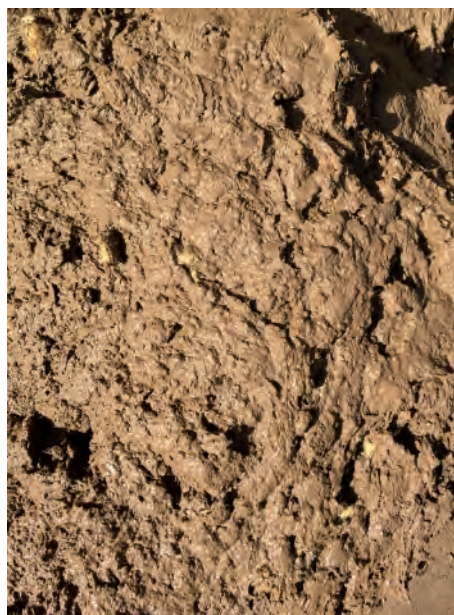
Figura 41. (Daniela Cruz Martínez, 2020) Mezcla final con 1% de acetato de celulosa.
