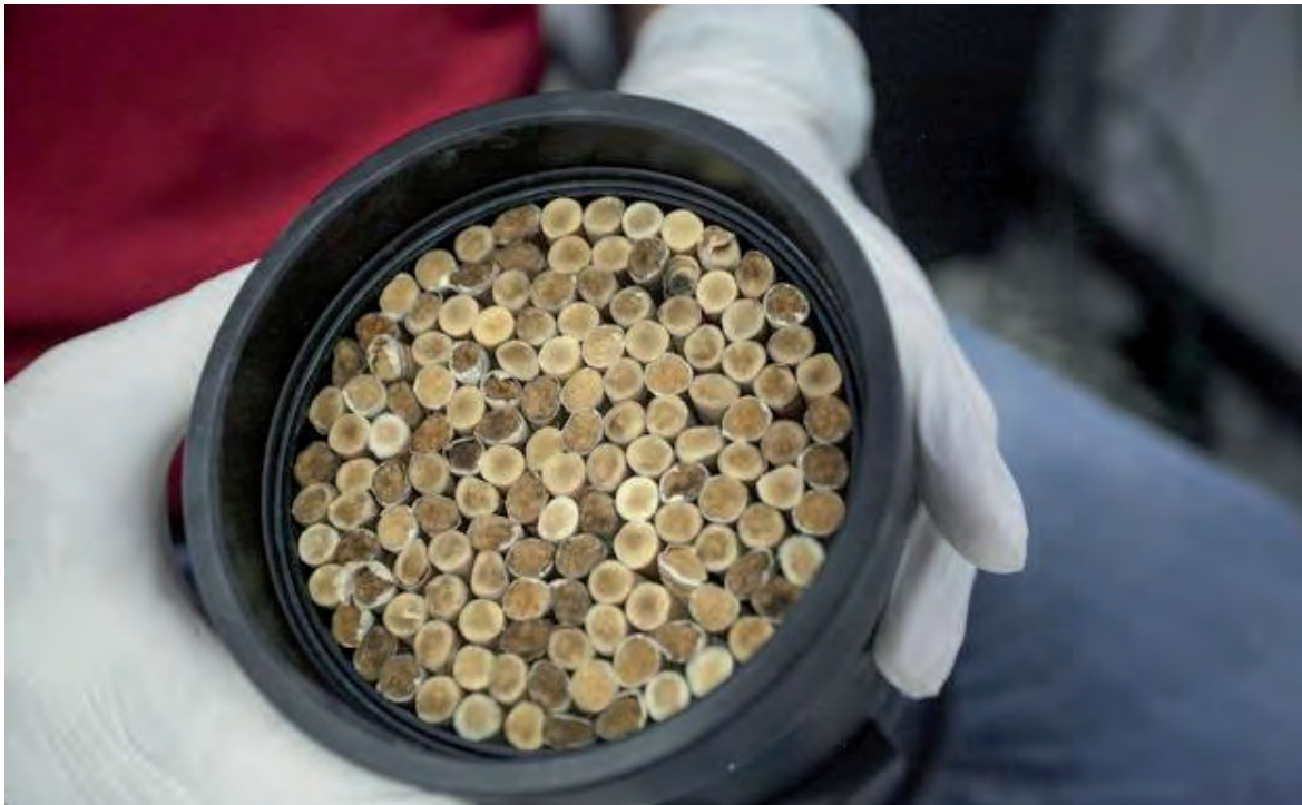
Figura 22. (Sinc. 2017) Las colillas de cigarrillos comprimidas en un contenedor especial para medir el coeficiente de transmisión acústico. Gráfico recuperado de la red.
