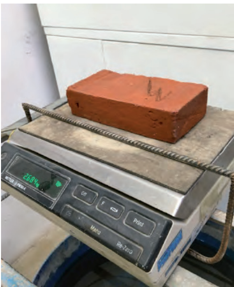
Figura 91. (Daniela Cruz Martínez, 2021) Muestra 3, medición de la masa saturada con agua.
