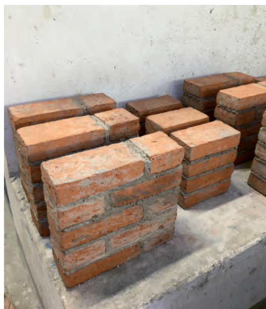
Figura 97. (Daniela Cruz Martínez, 2021) Muretes contruidos por muestras del material compuesto (al frente) y muretes contruidos por muestras control (fondo lateral).
