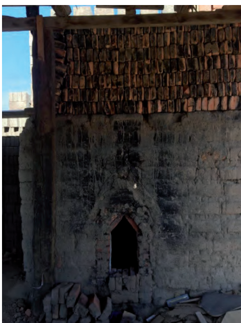
Figura 50. (Daniela Cruz Martínez, 2020) Horno utilizado durante el proceso de cocción.
