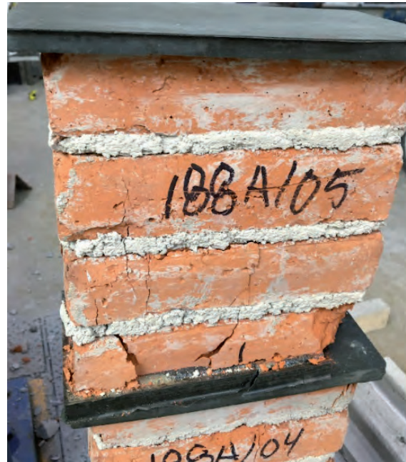
Figura 87. (Daniela Cruz Martínez, 2021) Probeta 188A-04 y 188A-05 tras ceder ante la falla.
