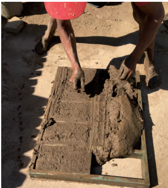
Figura 38. (Daniela Cruz Martínez, 2020) Molde de PTR utilizado para fabricar las muestras.
