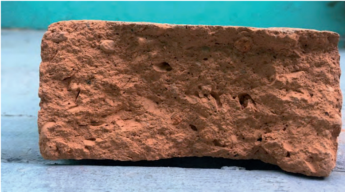
Figura 54. (Daniela Cruz Martínez, 2020) Ejemplar perteneciente a las muestras control en corte transversal.
