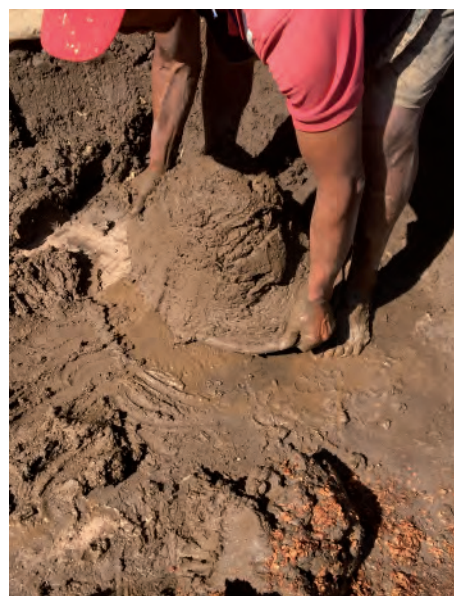
Figura 43. (Daniela Cruz Martínez, 2020) Mezcla con contenido del 1% de acetato de celulosa.
