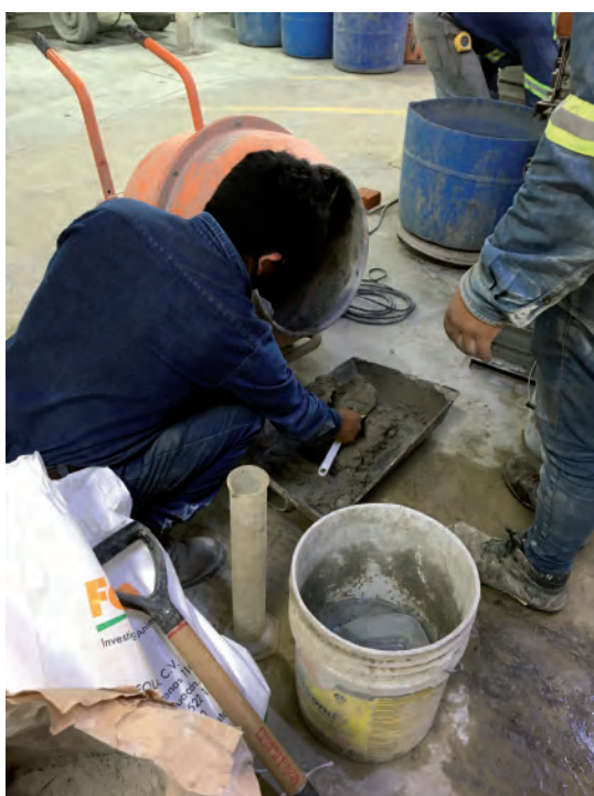
Figura 63. (Daniela Cruz Martínez, 2021) Mezcla para la fabricación de cubos de mortero de junteo.
