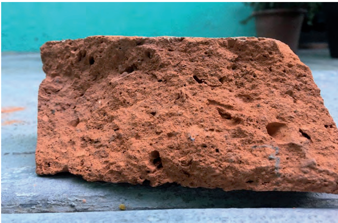
Figura 55. (Daniela Cruz Martínez, 2020) Ejemplar perteneciente a las muestras con contenido del 1% de acetato de celulosa en corte transversal.
