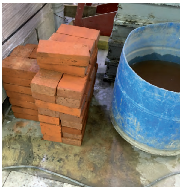
Figura 96. (Daniela Cruz Martínez, 2021) Ladrillos fabricados a partir de la mezcla de arcilla con acetato de celulosa, muestras individuales.
