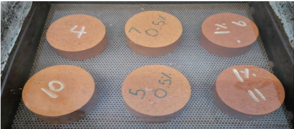
Figura 23. (Mohajerani y Kurmus, 2017) Muestras con contenido de acetato de celulosa. Recycling of Cigarette Butts in Fired Clay Bricks: A New Laboratory Investigation. Gráfico recuperado de la red.
