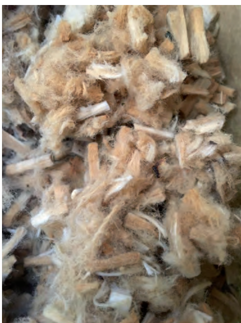
Figura 31 y 32. (Daniela Cruz Martínez, 2020) Acetato de celulosa con apariencia similar a una fibra textil tras triturarse en la licuadora.
