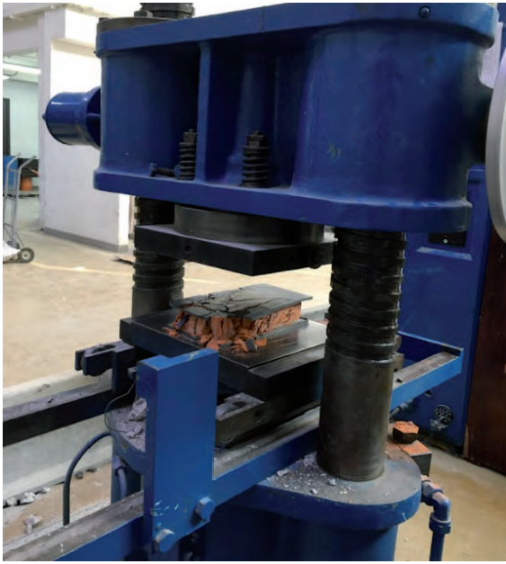
Figura 76. (Daniela Cruz Martínez, 2021) Falla del material tras ser sometido a una carga máxima.
