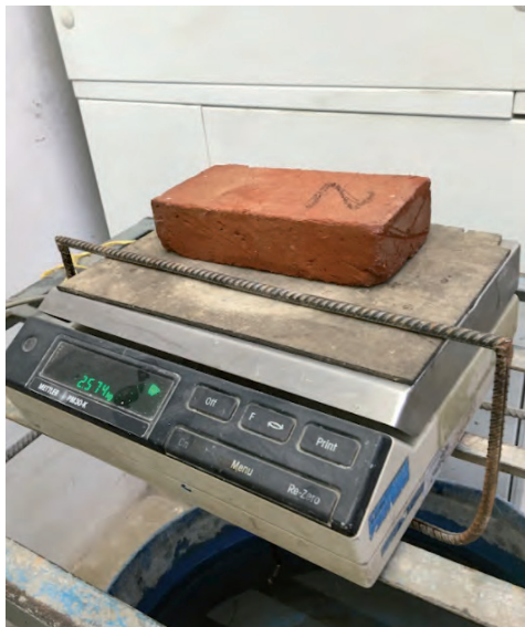
Figura 90. (Daniela Cruz Martínez, 2021) Muestra 2, medición de la masa saturada con agua.
