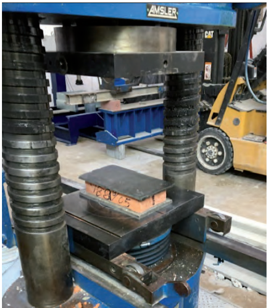
Figura 75. (Daniela Cruz Martínez, 2021) Muestra de material compuesto en ensayo a compresión.
