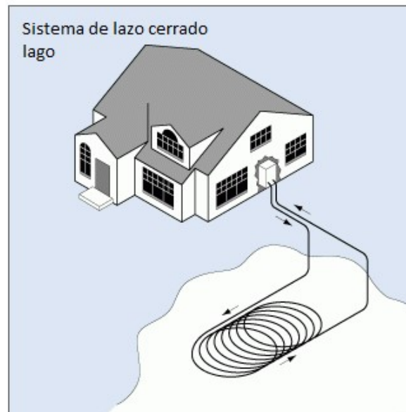
Figura 6 Diagrama de arreglo de lazo de estanque, tomado de la empresa Kocher's – water pumps & tanks Inc
