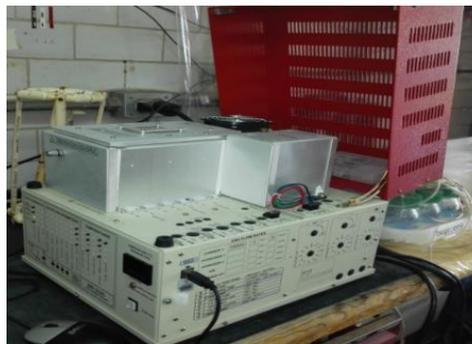
Figura 3.7. Equipo de cromatografía de gases Perkin Elmer Modelo CG-SRI310c
