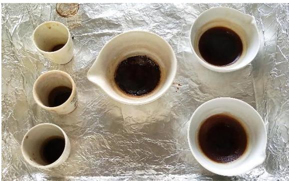
Figura B1. Determinación de sólidos totales (crisoles y cápsulas)
