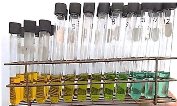
Figura B3. Curva de calibración para la determinación de DQO
