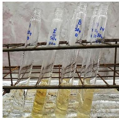
Figura B6. Determinación  $\text{SO}_4^{2-}$ : Blanco, VC, influente y efluente (izq. a der.)
