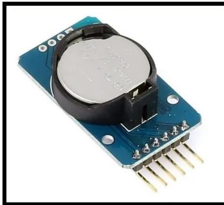
Fig. 34: Módulo reloj de tiempo real con comunicación I2C DS3231 [54].
