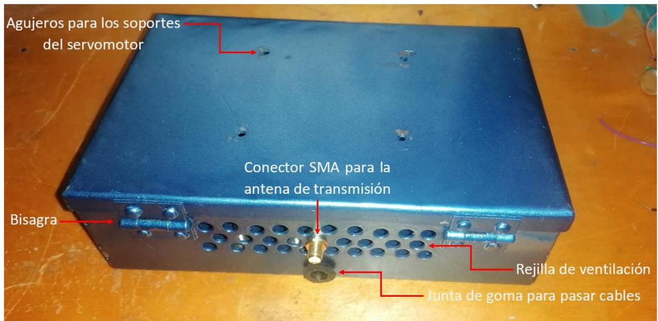
Fig. 46: Vista posterior de la carcasa metálica del instrumento.
