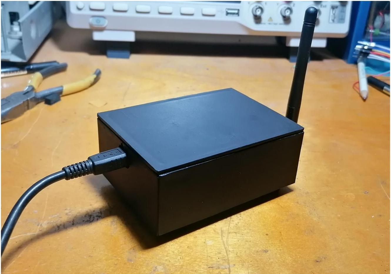
Fig. 65: Módulo RF receptor de datos: Serial-USB.
