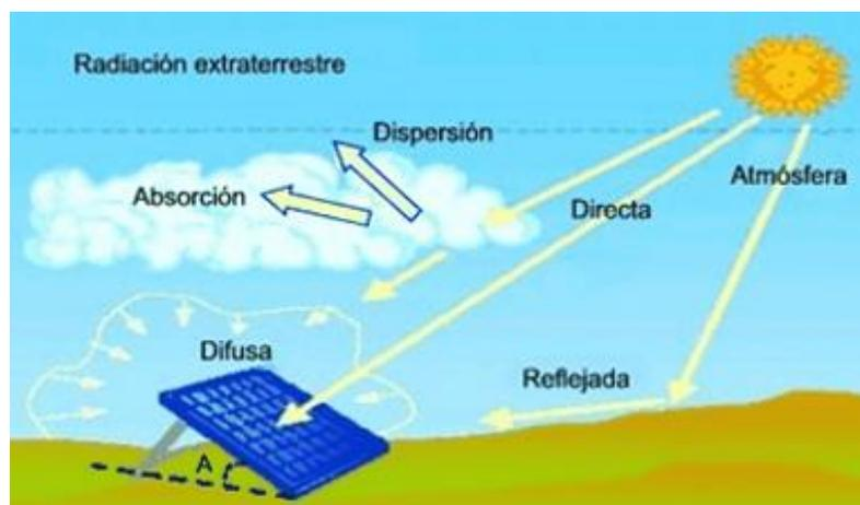
Fig. 7: Dispersión, reflexión y absorción de la luz: Radiación solar difusa y radiación solar directa [35].
