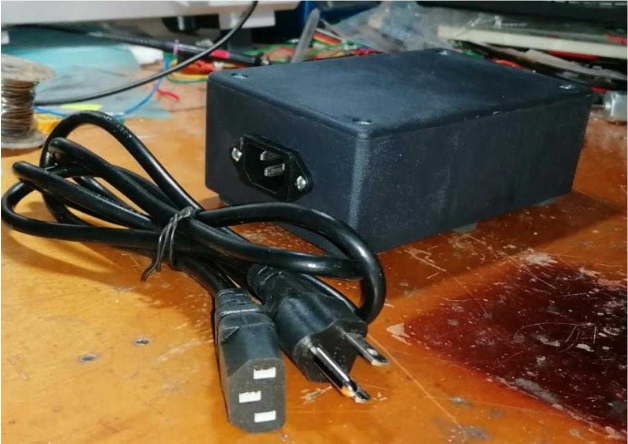
Fig. 55: Fuente lineal de bajo ruido 5V, 1A.
