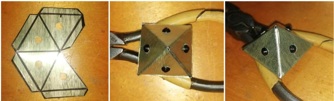
Fig. 18: Construcción de un opto sensor piramidal.
