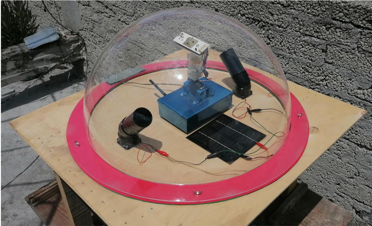
Fig. 67: Integración Final de subsistemas. Estación de monitoreo de la radiación UV.
