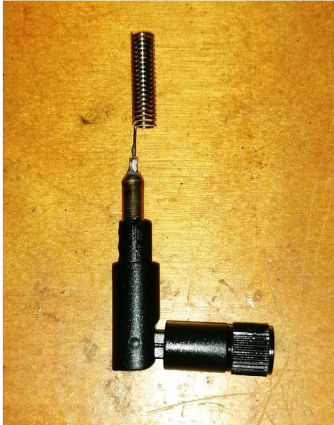
Fig. 49: Antena monopolo externa de 433 MHz.
