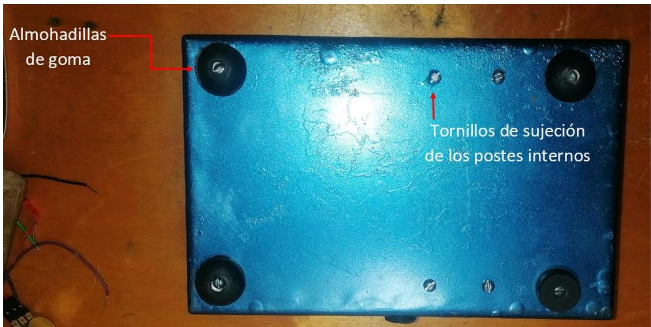
Fig. 47: Vista inferior de la carcasa metálica del instrumento.
