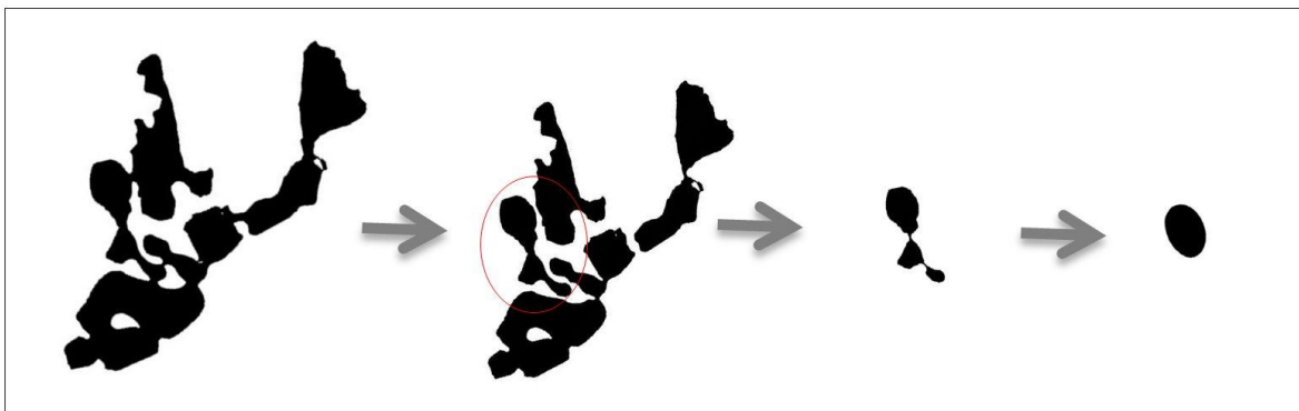
Figura 3.59 Mecanismo de disolución para la fase Al_2Cu eutéctica.
