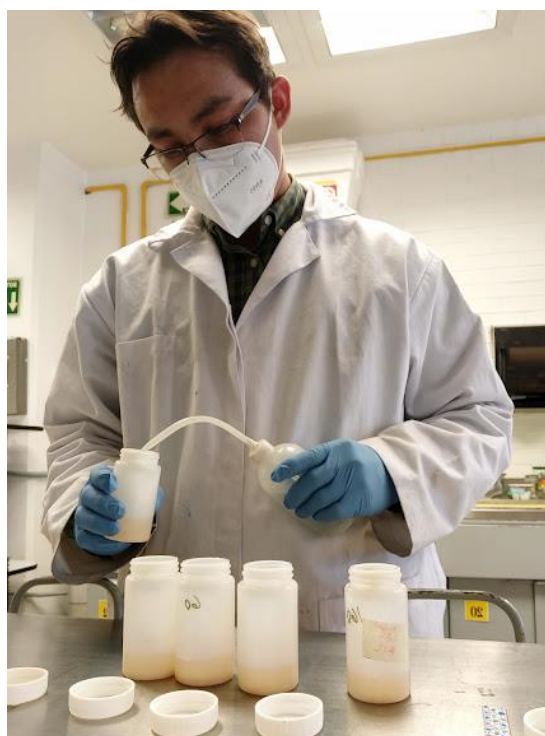
Figura 19. Lavado del material resultante de la desacetilación con pretratamiento ultrasónico.
