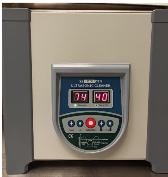
Figura 18. Baño de ultrasonido con capacidad de 6 L empleado durante el pretratamiento ultrasónico.
