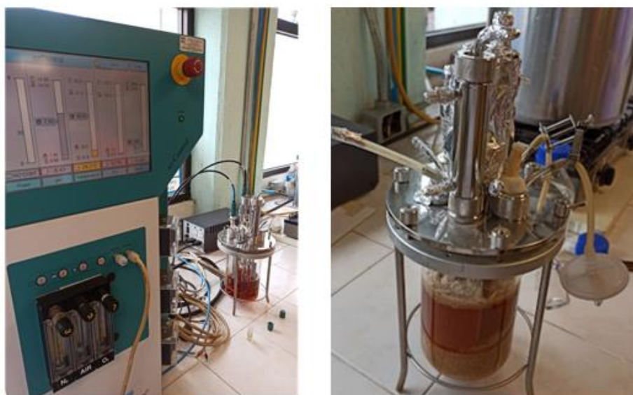
Figura 23. Producción de extracto crudo enzimático rico en deacetilasas a nivel biorreactor.
