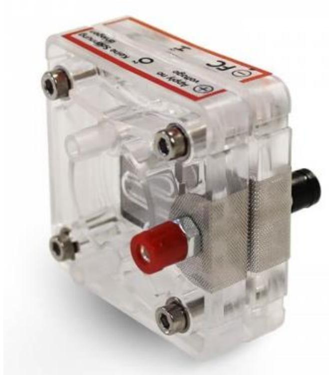
Figura 2. Celda combustible tipo PEMFC [12].
