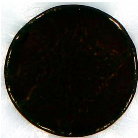
Figura 13. Capa de tinta colocada sobre electrodo para las pruebas del material **Ru@MIL-100(Fe)MA24**, fotografía tomada con microscopio digital USB.
