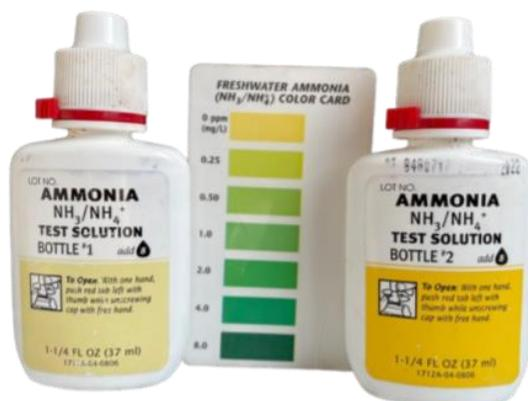
**Figura 3.5.6.** Kit colorimétrico para determinar la concentración total de nitrógeno amoniacal, reactivos indicadores y tabla colorimétrica.
