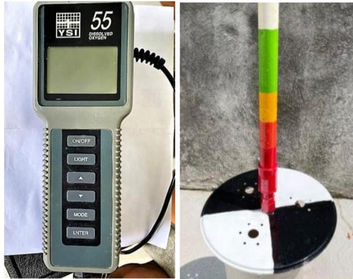
**Figura 3.5.3.** Equipo para medir el oxígeno disuelto (OD) del estanque. A la derecha se presenta un oxímetro, este permite medir directamente el OD; a la izquierda se presenta el Disco de Secchi graduado en 15, 20, 25, 30 cm con los colores rojo, naranja, amarillo y verde respectivamente.
