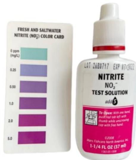
**Figura 3.5.8.** Kit colorimétrico para determinar la concentración de nitritos, reactivos indicadores y tabla colorimétrica.
