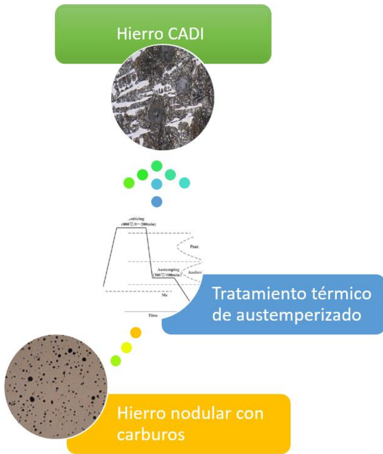
Figura 14. Representación esquemática del proceso de fabricación de un hierro CADI. Fuente: imágenes adaptadas de (35).
