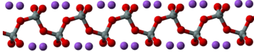
Figura 4.11 Estructura del Silicato de Sodio ( ceramica.fandom.com, 2021 )
