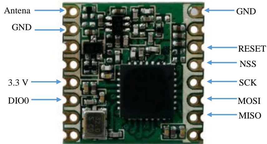
Figura 3.2. RFM95W denominado en el diagrama electrónico como U2 y U5 [11].
