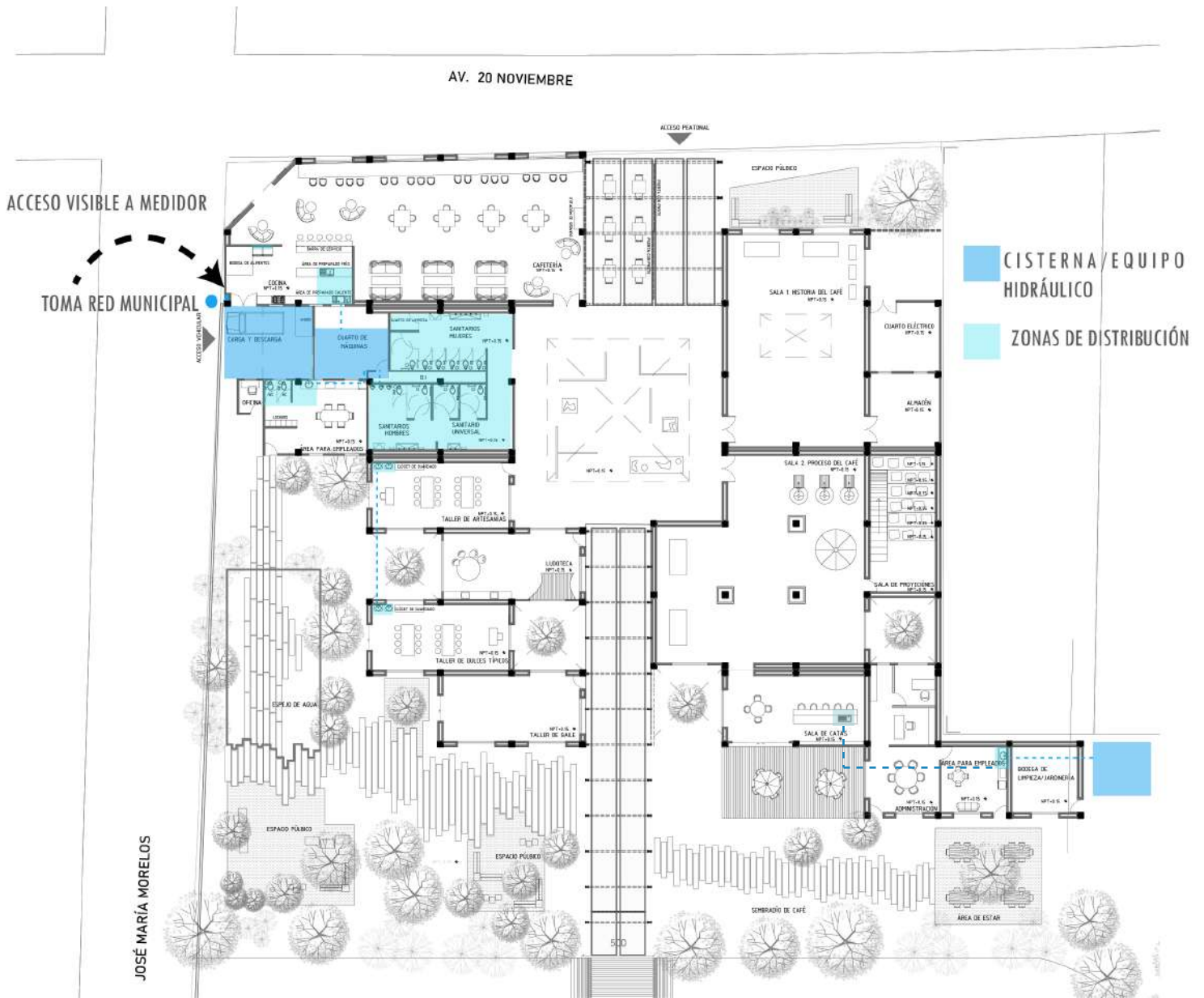
IMAGEN 60. Croquis de criterio hidráulico Proyecto Centro Cultural del Café en Orizaba, Elaboración propia.
