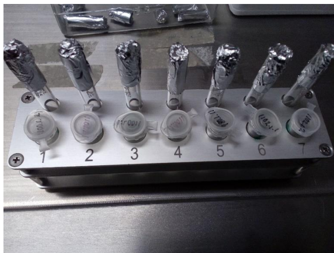
Figura 6-15: Hierro en tubos para colocar en el AGEIII.
