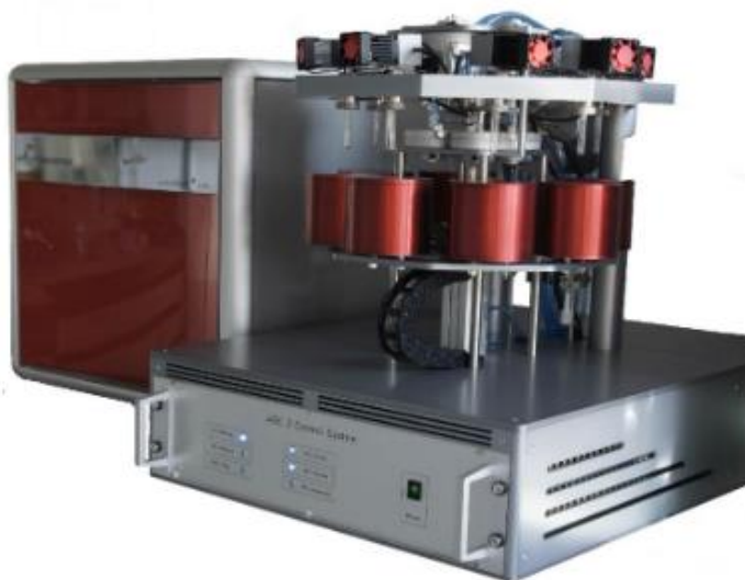
Figura 6-17: Equipo de grafitización automatizado AGEIII [18].
