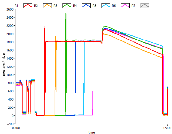
Figura 12-12: Gráfica del proceso de grafitización de la corrida 20181030. Durante la reacción la presión no baja, al no haber \text{CO}_2 , por lo que se dejó correr 50 min y después la reacción se detuvo manualmente.
