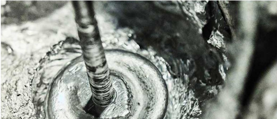
Figura 1.1 Agitación mecánica de una aleación base aluminio. Extraído de [2].
