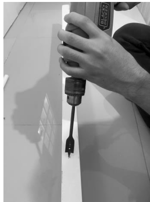
Fig. 7. Elaboración del kit para el FMS™, elaboración de orificios en tabla principal.
