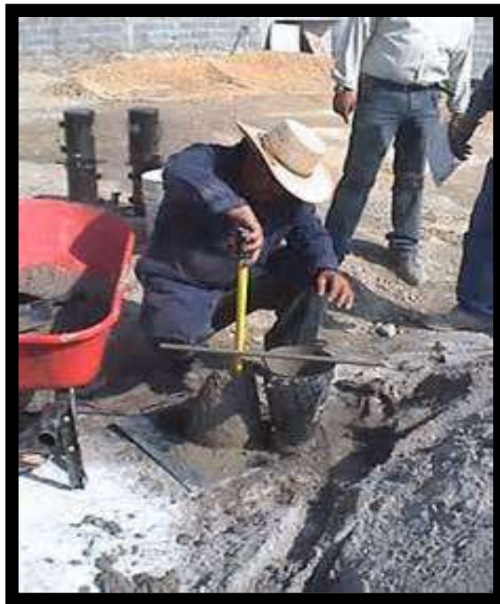
Fig. 5.- Determinación del Revenimiento de acuerdo a especificación.
