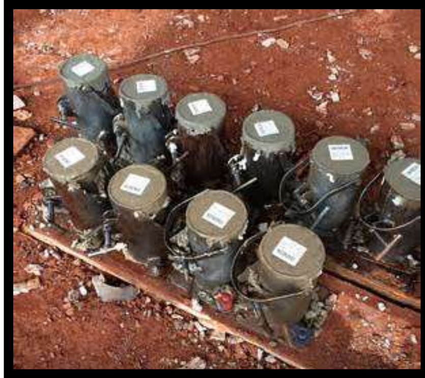
Fig. 6.- Muestras elaboradas del Concreto en estado fresco
