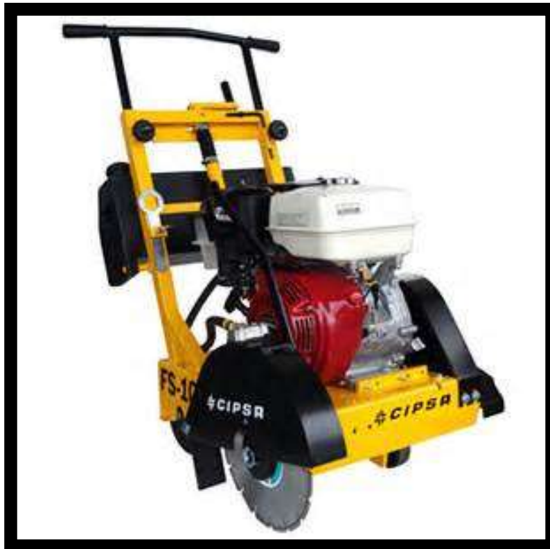
Fig. 36.- Sierra con disco de diamante para cortes en concreto.
