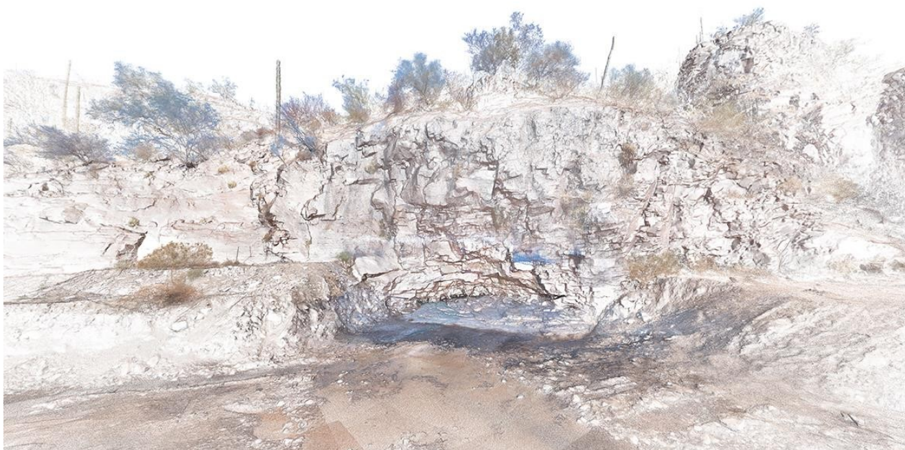
Modelo tridimensional del sitio generado a partir de nube de puntos producto del registro láser. Imagen generada por el Laboratorio de Documentación y Análisis Tridimensional de la CNCPC del INAH, 2018. Tomado de: Cruz, S., 2019, p. 4.
