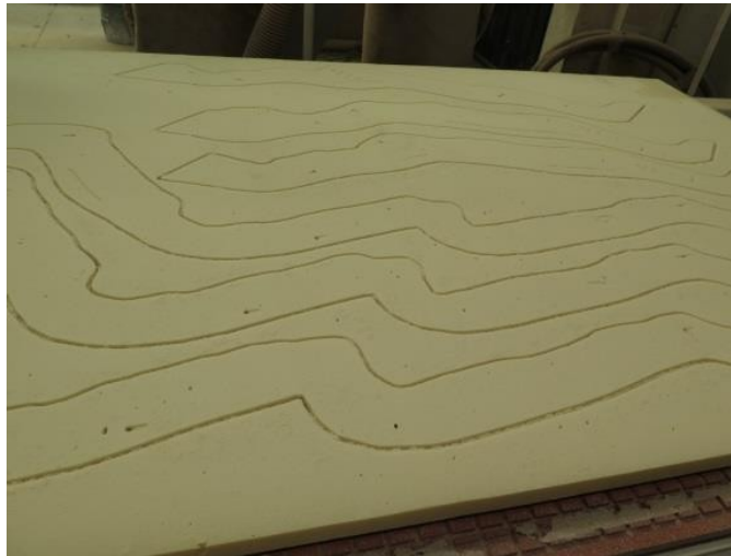
Detalle de una lámina de espuma plástica cortada por medio del router.
