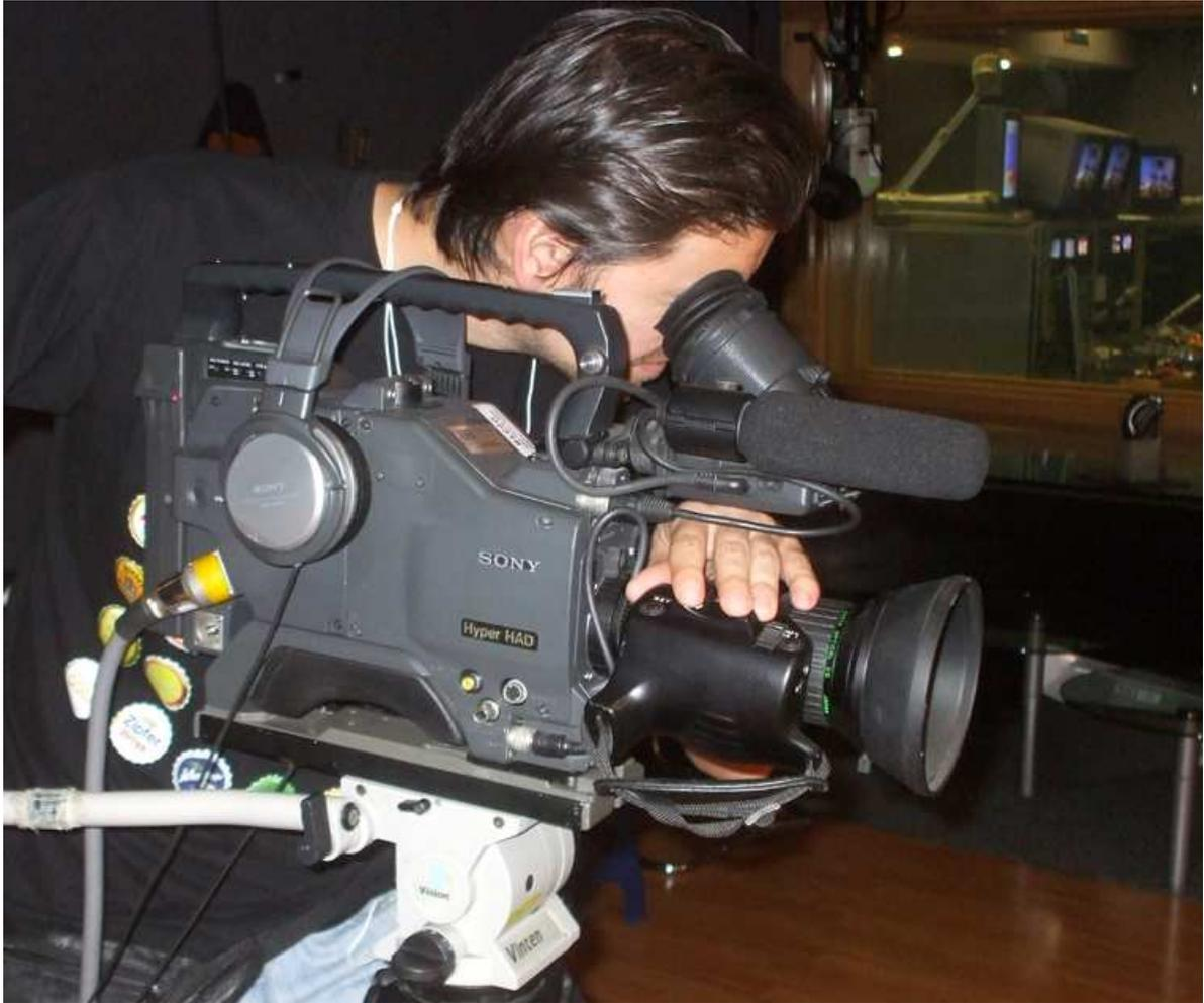
Fig. 15. Un buen tripié hidráulico como el de la imagen es garantía de estabilidad en cualquier movimiento que se desee.
