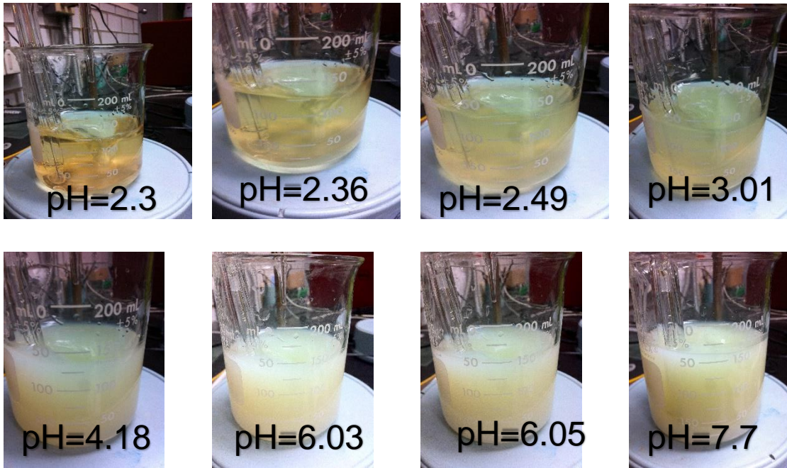
Figura A3.3 Precipitación de fosfatos en DAM de la boca de mina del socavón 1412 con \text{PO}_4^{3-} 0.2 \text{ mol L}^{-1}
