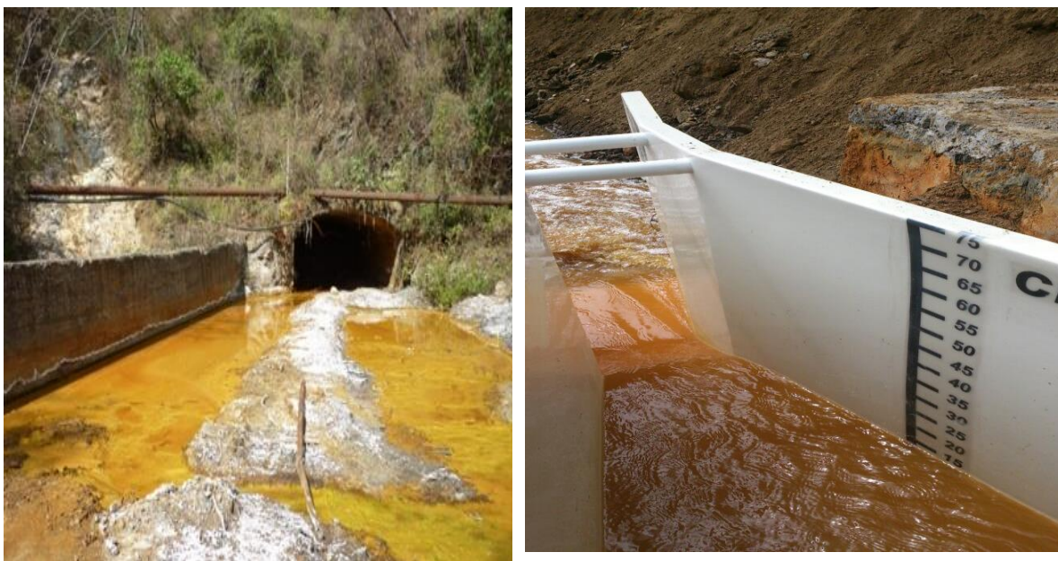
Figura 3. Drenaje Ácido de Mina (DAM) procedente del Socavón 1412 en Taxco, Guerrero.
