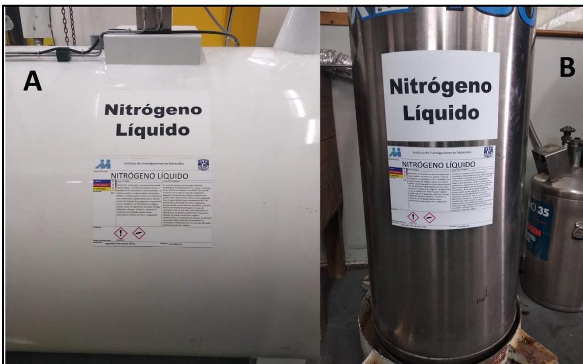
Imagen 4. a) Fotografía de tanque de nitrógeno con el etiquetado que diseñamos de acuerdo con el SGA. b) Fotografía de parte de sistema de licuefacción con el etiquetado correspondiente al SGA
