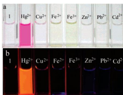
Figura 19. Estudio de selectividad y fluorescencia del sensor selectivo de \text{Hg}^{2+} .
