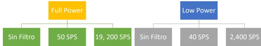
**Figura 4.2:** Casos de medición con ADC7124-8 y Raspberry Pi Pico.
