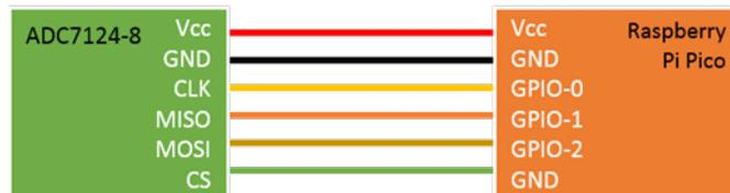
Figura 3.10: Diagrama de conexión para la comunicación SPI.
