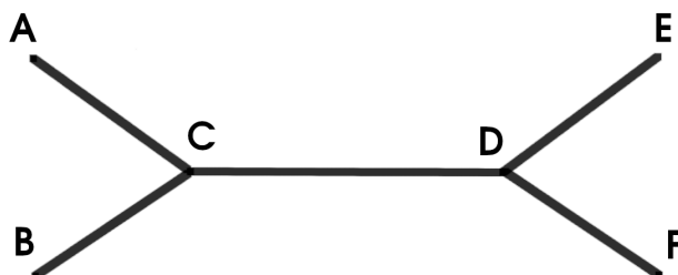
Figura 2.4 – Combinaciones de átomos que forman ángulos diedros en los enlaces rotables del tipo sp^2 - sp^2 (conexión C-D) presentes en las moléculas trabajadas. Se encuentran cuatro posibles combinaciones A-C-D-E, A-C-D-F, B-C-D-E y B-C-D-F. Por simetría B-C-D-F puede describirse por la misma función periódica que A-C-D-E. Por simetría B-C-D-E y A-C-D-F tienen un \tau = \tau_{ACDE} + 180 n_{ACDE} , ya que sus ángulos se pueden representar como \phi = \phi_{ACDE} + 180 (ecuación 2.1). Por esta razón, encontrar los parámetros de cualquiera de estas cuatro combinaciones permite saber cuáles son las funciones periódicas que describen a las demás.
