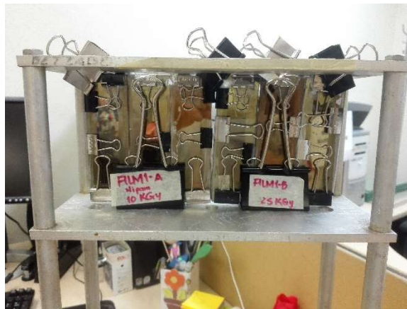
Figura 18. Arreglo de placas listo y colocado en el soporte para ser irradiado.
