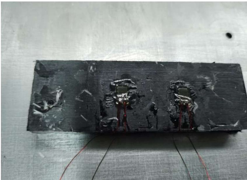
Figura 30. Preparación de las probetas para la prueba de relajación de esfuerzos.
