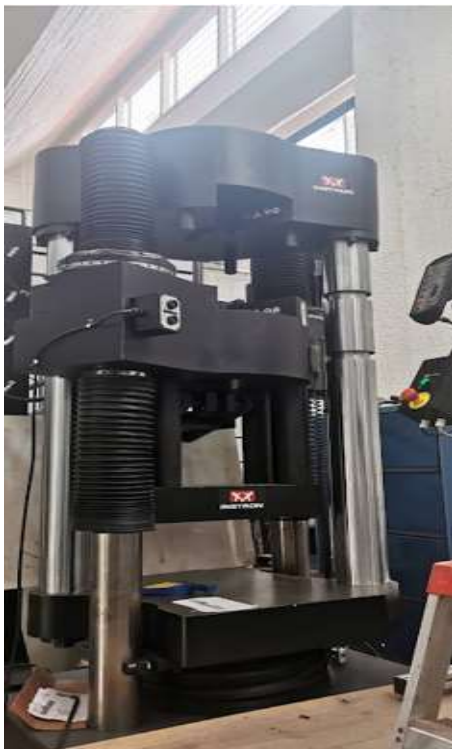
Figura 29. Máquina de pruebas universales utilizada para las pruebas a tensión. LMSE, Facultad de Arquitectura UNAM.
