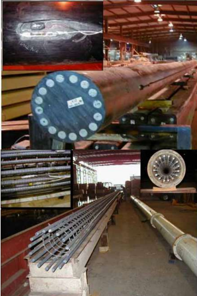
Figura 18. Fabricación de pilotes marítimos, con matriz polimérica termoplástica.
