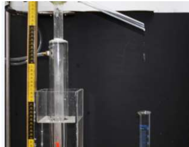
Figura 5.5 Fotografía del flujo bache a .5 [kg/cm 2 ]
