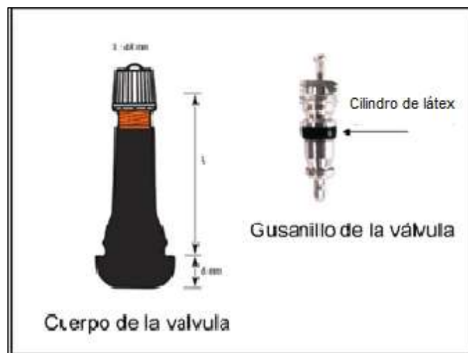
Figura 3.3 Esquema de una válvula para el inflado de neumáticos y el gusanillo que se rosca dentro de la válvula, el cilindro de látex es el que impide el contra flujo de gas a través de los orificios de inyección.
