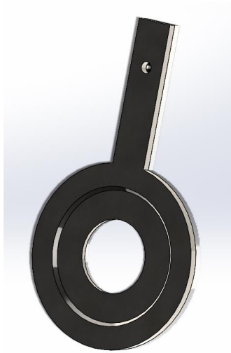
Figura 3.8 Diseño en CAD de la placa orificio para el ciclo binario de 100 kW.
