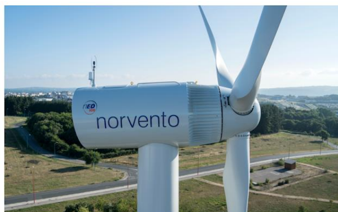
Figura 4.16 Aerogenerador de 100 kW "nED 100" para autoconsumo industrial.
