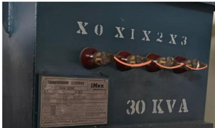
1.2.- Una vez terminado el paso 1.1., se cortocircuitaron las bobinas  $H_1$ ,  $H_2$ ,  $H_3$  (figura 38) con ayuda de un cable desnudo o 2 cables caimanes.
