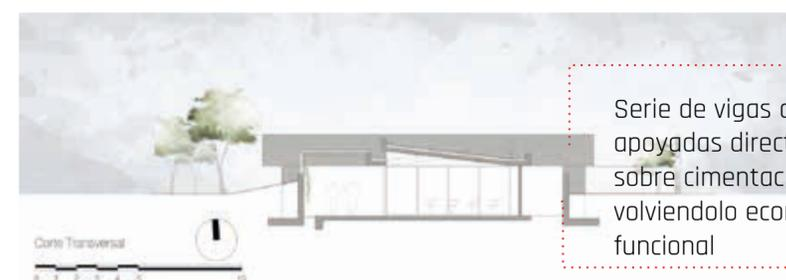
Serie de vigas de hormigón apoyadas directamente sobre cimentación, volviendolo económico y funcional
