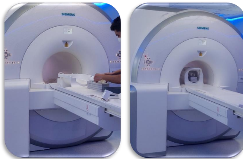
Figura 3.9. Fotografías que muestran la colocación de los maniqués de calidad de imagen en la antena cerebral y su posicionamiento en conjunto en el escáner Siemens Biograph mMR
