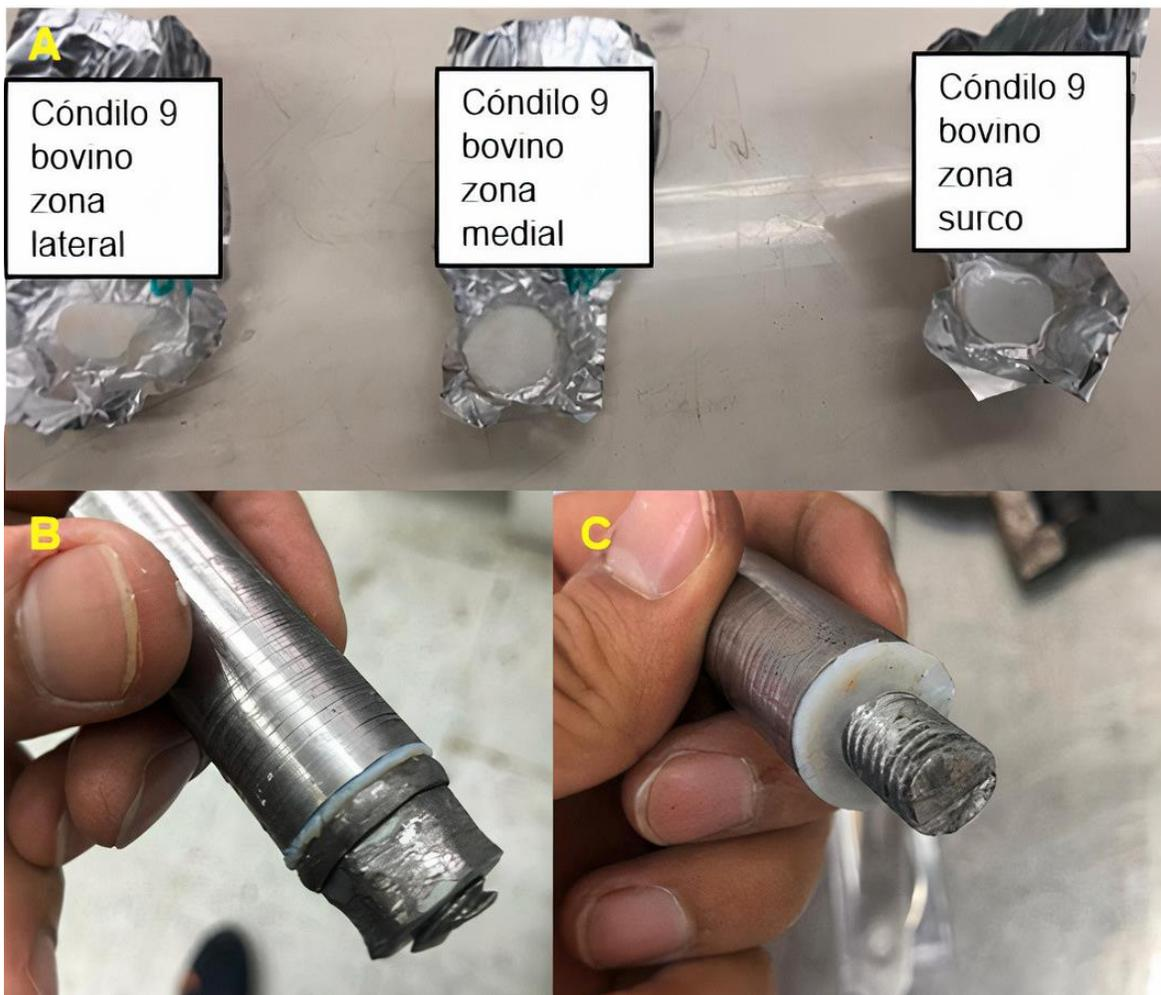
Figura 22. Probetas de CHA de cóndilo bovino para ensayo de esfuerzo cortante (A), probeta cortada en ensayo de esfuerzo cortante fija en el punzón fuera de la cámara (B), la probeta no sufrió cambios en su espesor (no hubo flujo de fluido intersticial) (C).
