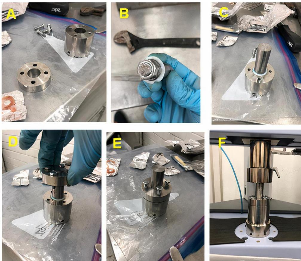
Figura 21. Montaje de probetas circulares de CHA para ensayo de esfuerzo cortante (A). La probeta se fija en el punzón móvil, que desliza por el orificio céntrico, con una rondana y una tuerca para fijar la muestra (B). Posteriormente ensamblada la probeta con los aditamentos, entra la parte superior de la base (C), se ajustan los tornillos (D-E), se empuja el punzón hacia abajo, hasta el corte de la probeta a una velocidad de 1.25 mm/min (F).
