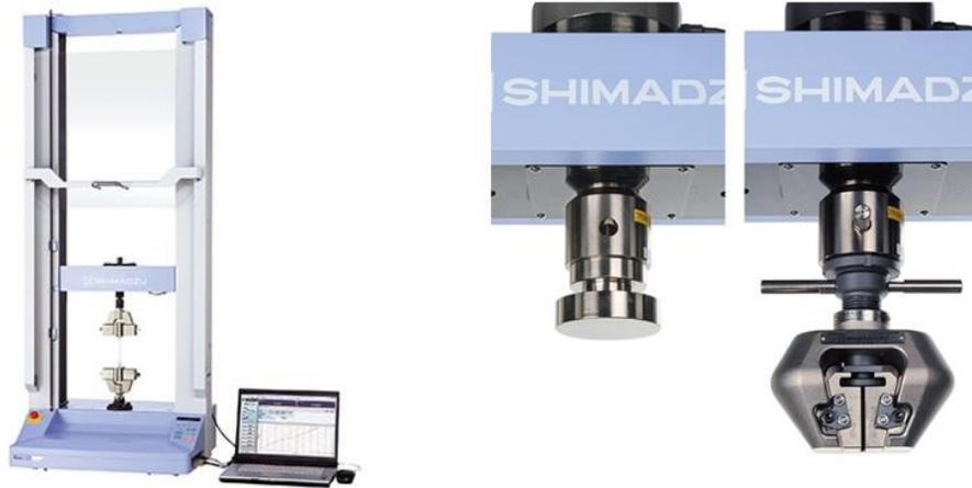
Figura 16. Máquina de ensayo universal Shimadzu AGS-X 10 kN y sus juntas para ensayos de compresión y de tensión.
