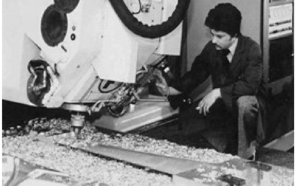
Figura 6. Máquina de control numérico en una de las plantas de fabricación de Dassault Aviation
