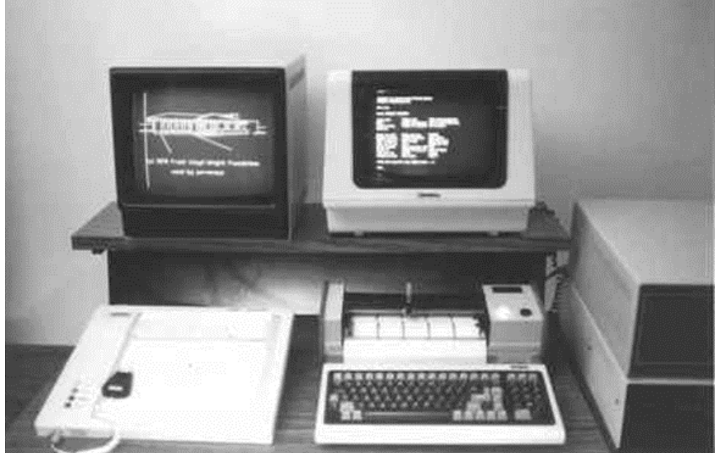
Figura 9. Vista de la Interfaz del Sistema CAD Interact en 1978
