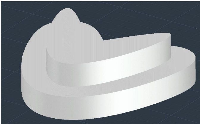
Figura 2.12. Vista sombreada de extruir del paso 6. (Captura del software AutoCAD)
